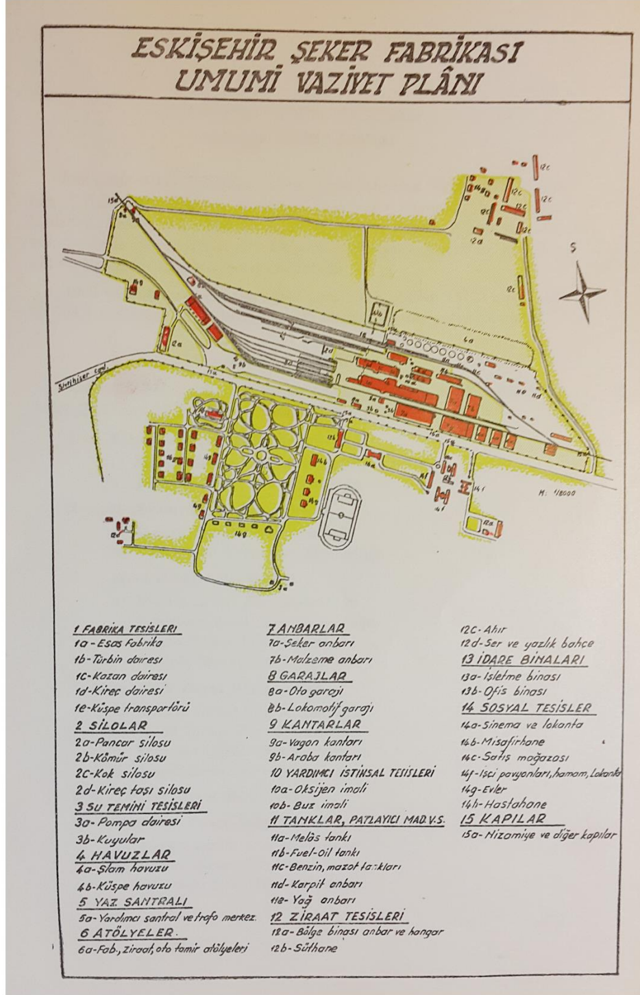
Şekil 1:Eskişehir Şeker Fabrikası'nın Vaziyet Planı
