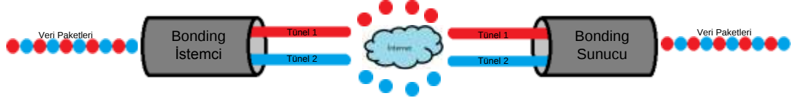
Şekil 3.2 Bonding Mode=0 (round robin) veri iletim algoritması
