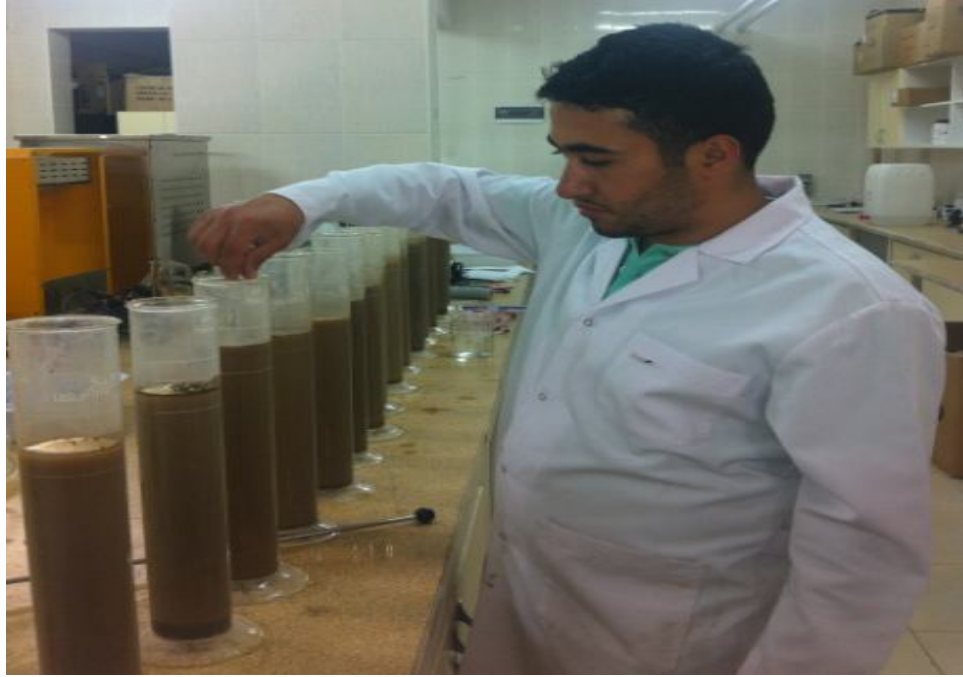
Şekil 2.4. Hidrometre Yardımı ile Okuma Değerlerinin Alınması
