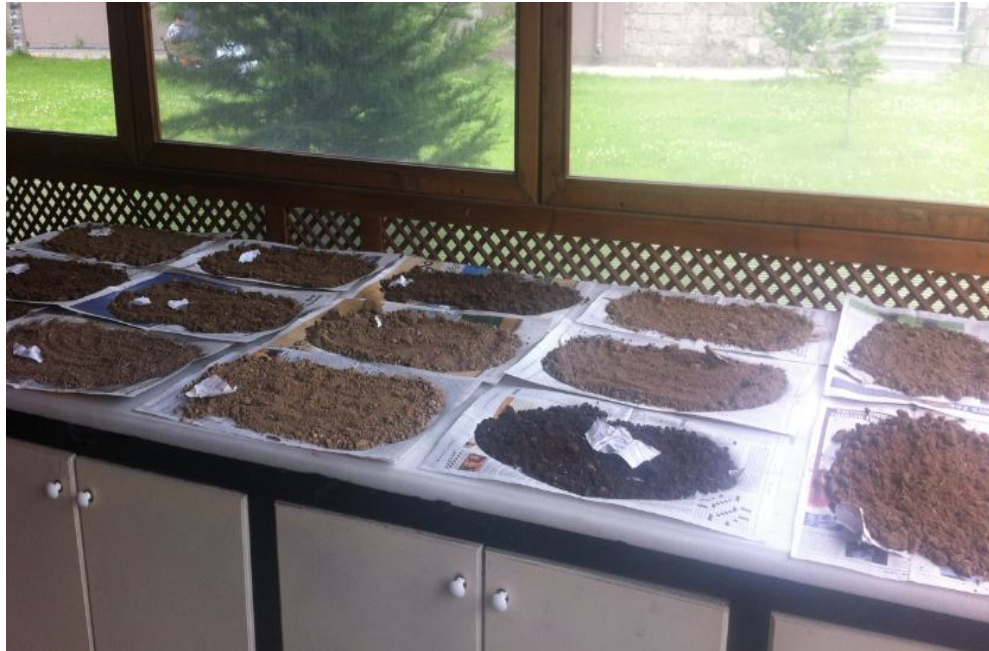
Şekil 2.3. Analiz Yapılmak Üzere Kurutulan Toprak Örnekleri
