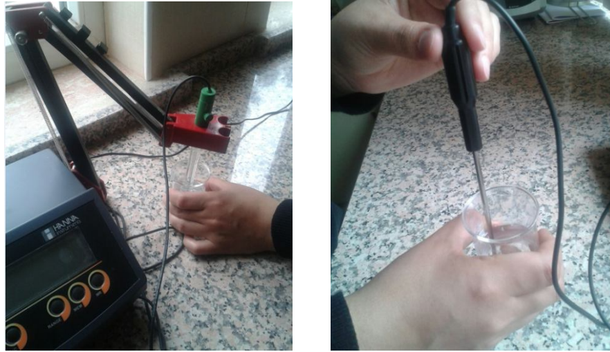
Şekil 2.5. Toprak Örneklerinin Ph ve Ec Ölçümü
