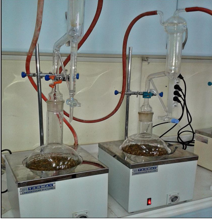
Şekil 3.5. Su Buharı Distilasyonu Metodu
