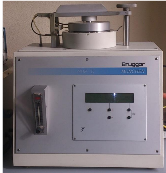
Şekil 3.8: ASTM D1434 yöntemine göre ölçüm yapan gaz geçirgenlik test sistemi.
