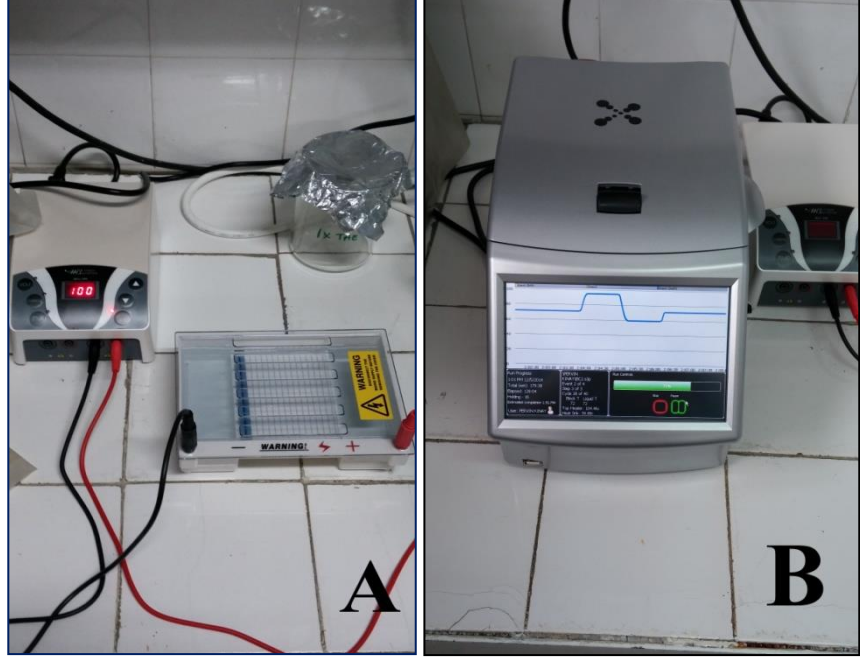
Şekil 3.3 Elektroforez jel tankı (A) ve güç kaynağı ve thermal cycler (B).
