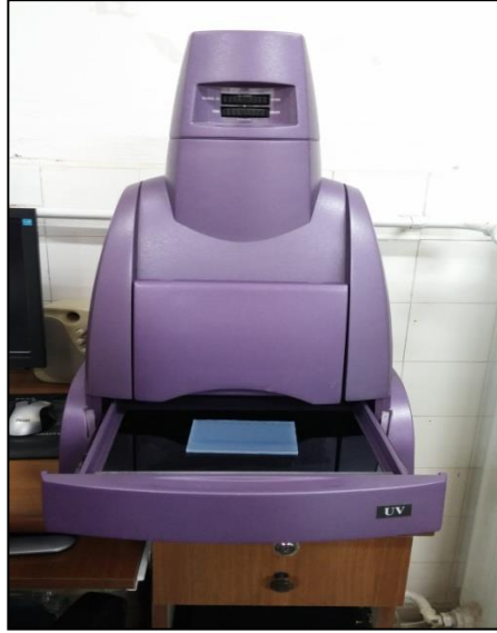
Şekil 3.4 Jel görüntüleme cihazı.
