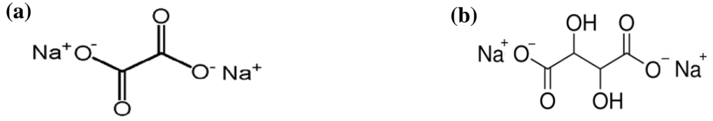
Şekil 3.1. Terpolimer film sentezinde kullanılan elektrolitlerin yapıları (a) sodyum okzalat ( \text{Na}_2\text{C}_2\text{O}_4 ) ve (b) sodyum tartarat ( \text{Na}_2\text{C}_4\text{H}_4\text{O}_6 )
