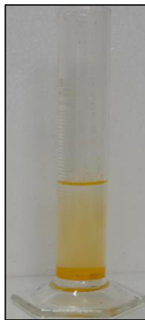
Şekil 3.8. \text{Pb}(\text{NO}_3)_2 ve KI çözeltilerinin karıştırılmasıyla \text{PbI} çökeleğinin oluşması
