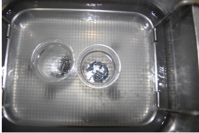
Şekil 3.4: Analogların ultrasonik temizleme aleti ile temizlenmesi
