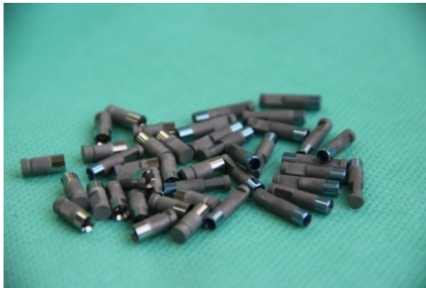
Şekil 3.5: 3 mm boyun kısmından itibaren kumlaman analoglar
