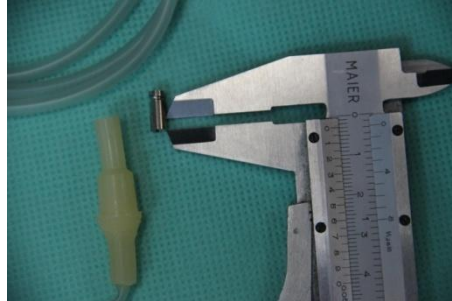
Şekil 3.1: Analogun 3 mm boyun kısmının belirlenmesi
