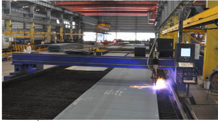
Şekil 4.4 İstasyon2 CNC Saç Kesimi
