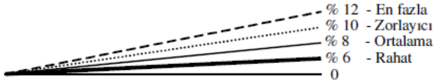
Şekil 2.17. Yaya rampalarında eğim (Bakan ve Konuk 1987)
