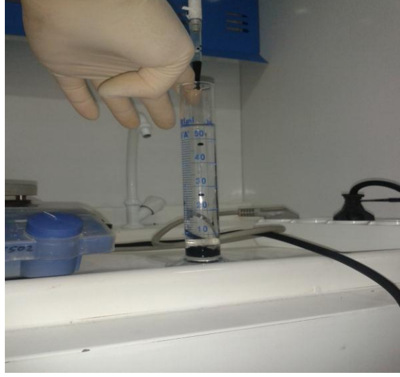
Şekil 3.1 AC/PAN Kürelerinin suya damlatılması
