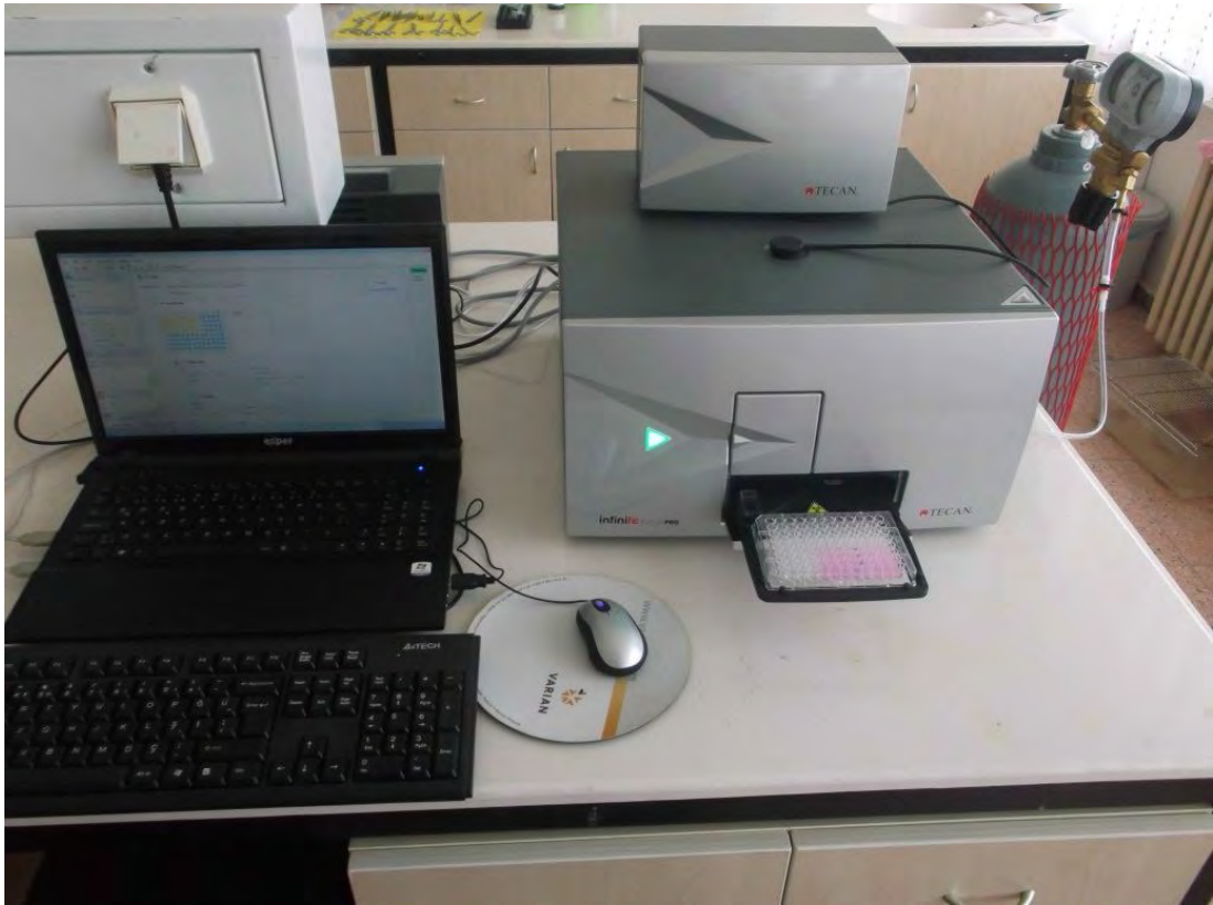
Resim 5. Analizlerin yapıldığı kuyucuk okuyucu (plate reader) cihazı
