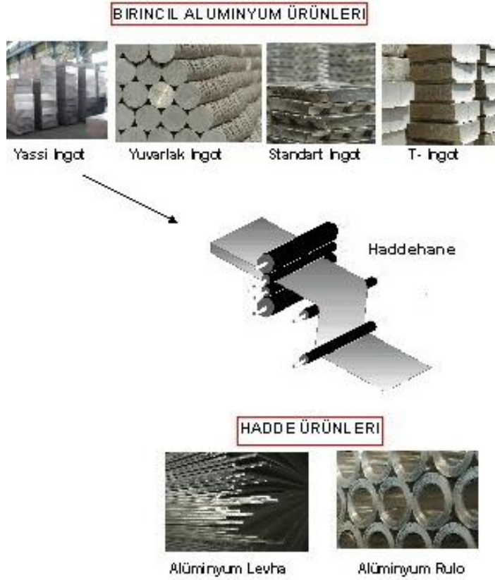
Şekil 2.8 : Birincil alüminyum ve hadde ürünleri.
