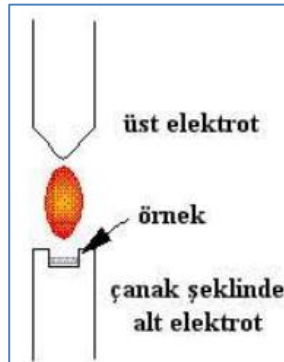
Şekil 2.17 : Ark/spark OES şematik görünümü [44].
