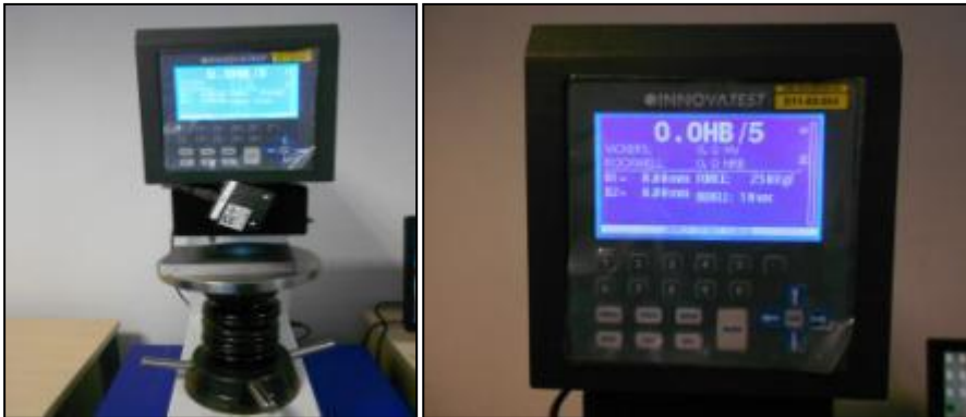
Şekil 2.24 : Sertlik ölçüm cihazı (sol) ve sonuç görüntüleme (sağ) [48].
