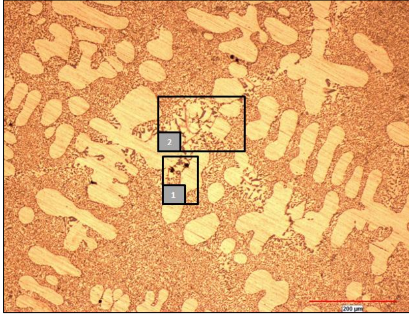
Şekil 3.30 : AlSi11Mg mikroyapısı içerisinde gaz boşluğu (1) ve Fe-Mn intermetalik oluşumu (2).
