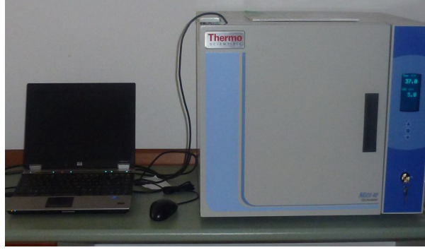
Şekil 3.13: xCELLigence sistemi bilgisayar ve inkübatörü
