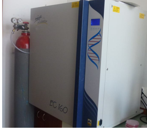
Şekil 3.5: %5 CO 2 içeren inkübatör
