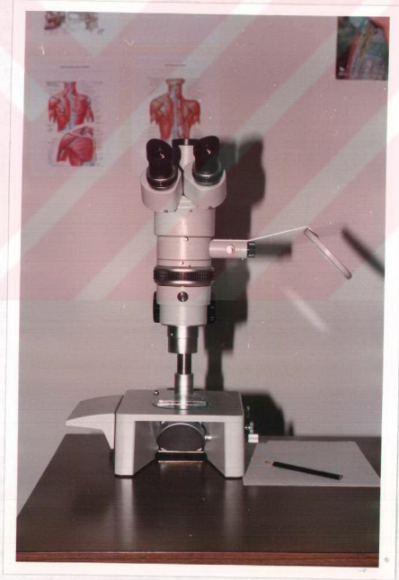
Şekil 22. 200 mikron aralıklarla alınan seri kesitlerin haritalandırılmasında kullanılan kamera lusida.
