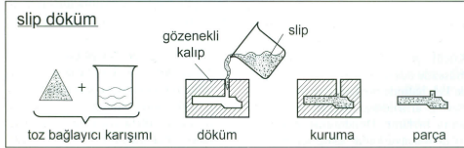
Şekil 5.3 : Slip döküm işleminin şematik gösterimi [16, 95, 96].
