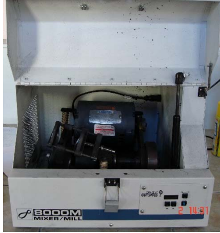
Şekil 4.13 : Mekanik alaşımlamada kullanılan yüksek enerjili bilyalı öğütücü.
