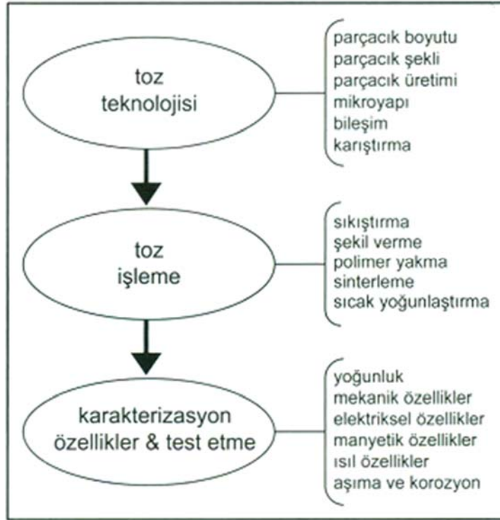
Şekil 4.4 : Toz metalurjisi proses akışı adımları [16, 95, 96].
