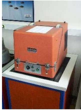
Şekil 4.14 : Gezegeen tipi öğütücü
