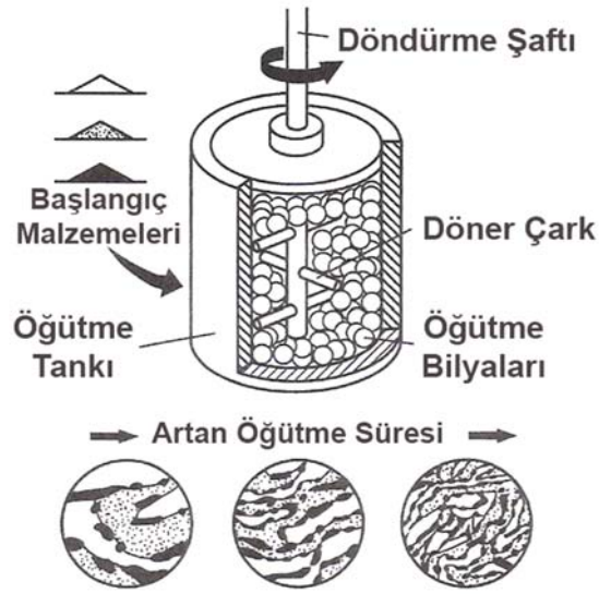
Şekil 4.8 : Mekanik alaşımlamanın süreçlerinin şematik gösterimi [16, 95, 96].
