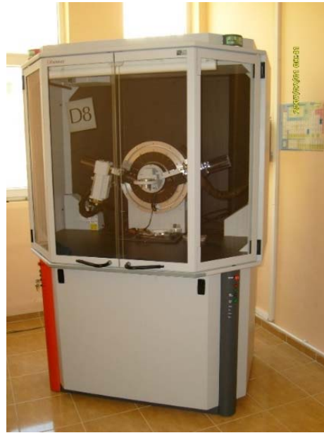
Şekil 7.7 : BRUKER™ X Işınları difraktometresi.
