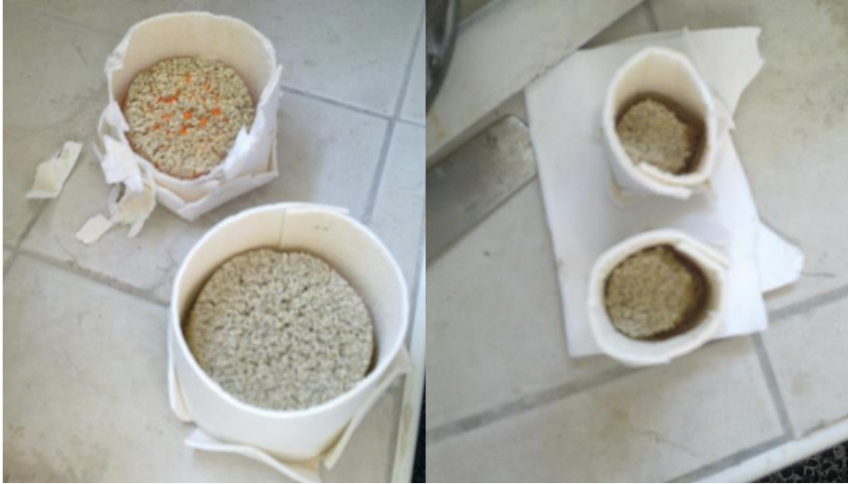
Şekil 2.5: Yüksek sıcaklık ve soğuma sonrası büzülme.
