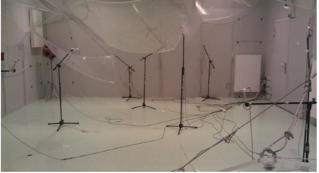
Şekil 1.12: TUBİTAK UME çınlanım odası.
