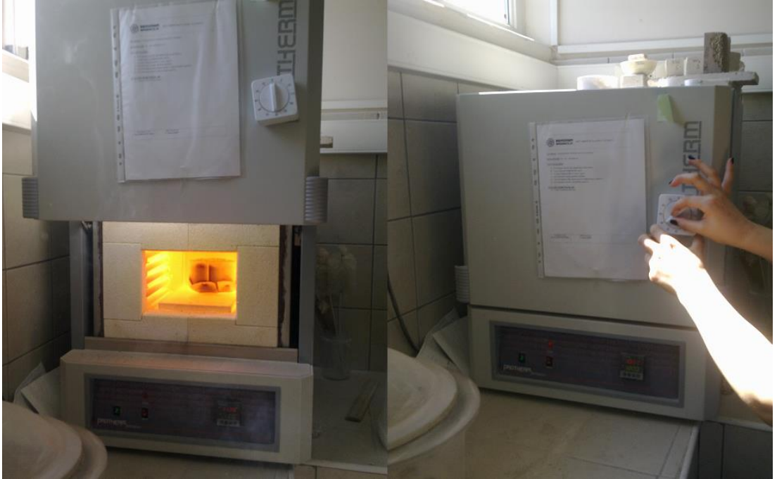
Şekil 2.3: Perlitin kül fırınına yerleştirilmesi.
