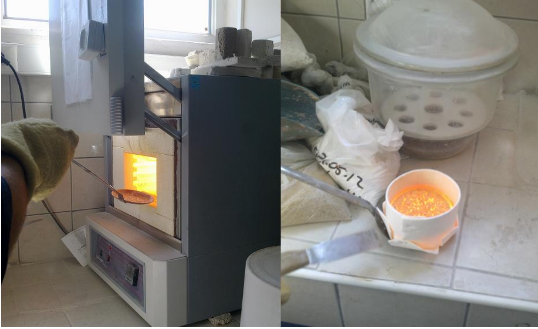
Şekil 2.4: Kalıbın kül fırınından çıkarılışı ve soğutulması.
