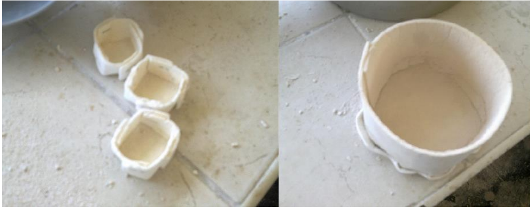
Şekil 2.1: Nutec Fibratex markalı seramik kağıttan kalıp oluşturulması.
