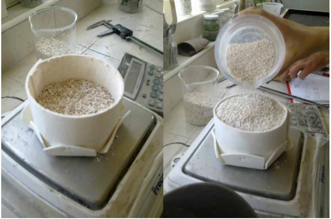
Şekil 2.2: Tabakalı perlit oluşturulması.
