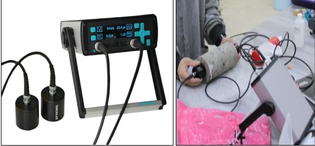
Şekil 4.18. Ultrasonik ses geiş hızı ölçümü ile basın dayanımı tespiti
