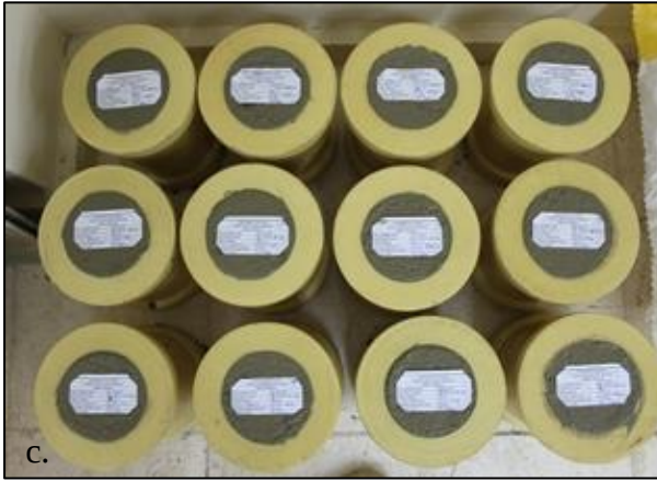
Şekil 4.10. Betonların kalıplara yerleştirilmesi
