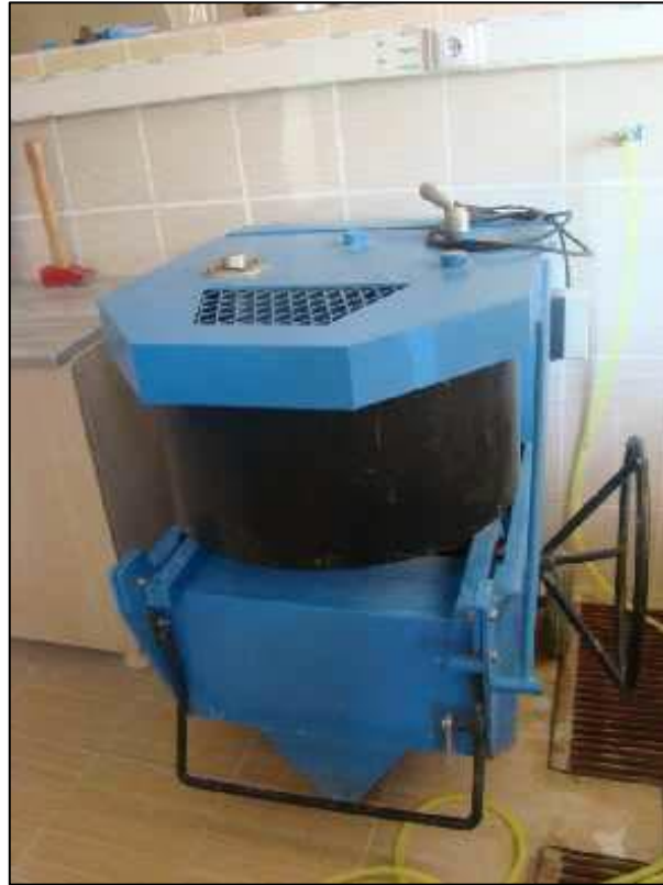
Şekil 4.7. Düşey eksenli cebri karıştırma mikser
