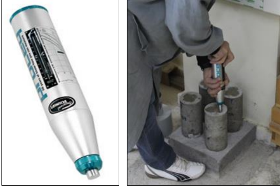
Şekil 4.16. Schmidt çekici ile basınç dayanımı tespiti
