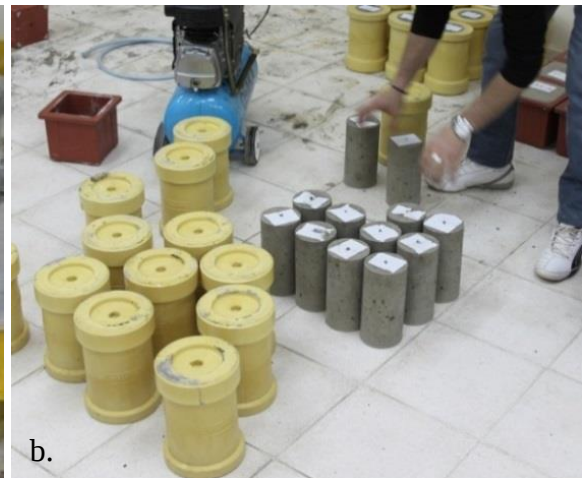
Şekil 4.11. Betonların kür edilmesi ve kalıplardan çıkarılması
