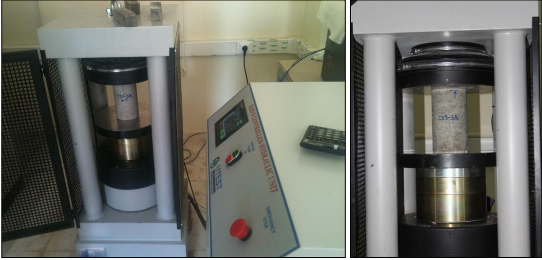
Şekil 4.15. Tek eksenli tahribatlı basınç dayanımı tespiti
