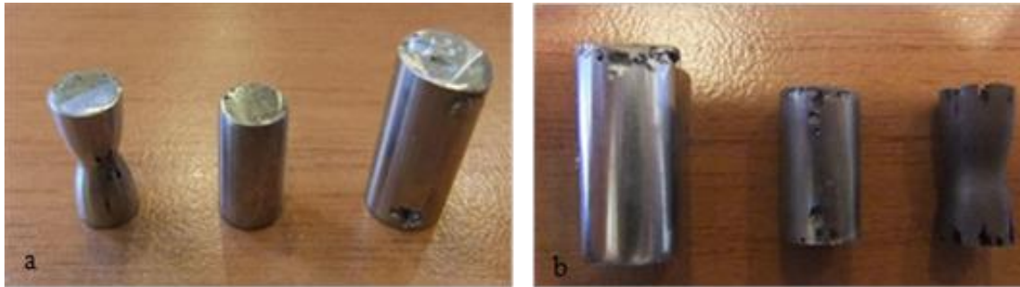
Şekil 3.22 : Korozyon testi sonrası makro görüntüler a) AISI 304 b) AISI 204Cu.
