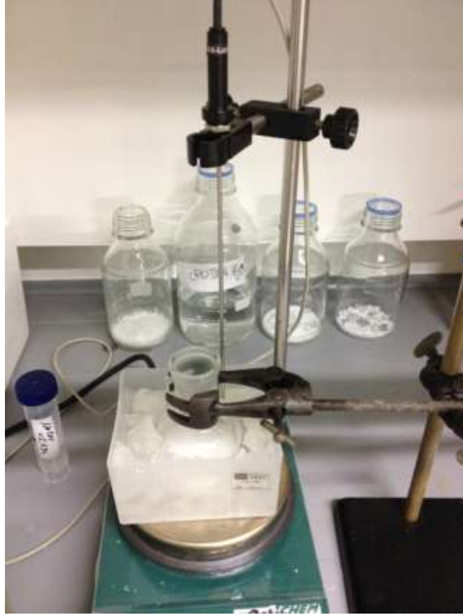
Şekil 4.4 Karıştırmalı 0°C buz banyosu homojenizasyon düzeneği
