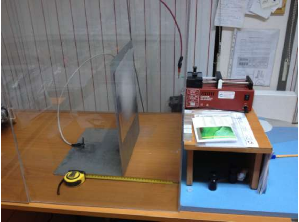
Şekil 4.1 Deneylerde kullanılan elektro-eğirme düzeneği
