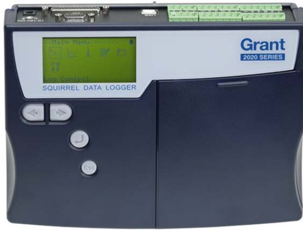
Şekil 3.4. Grant marka SQ2020-1F8 model veri toplayıcısının genel görünüşü
