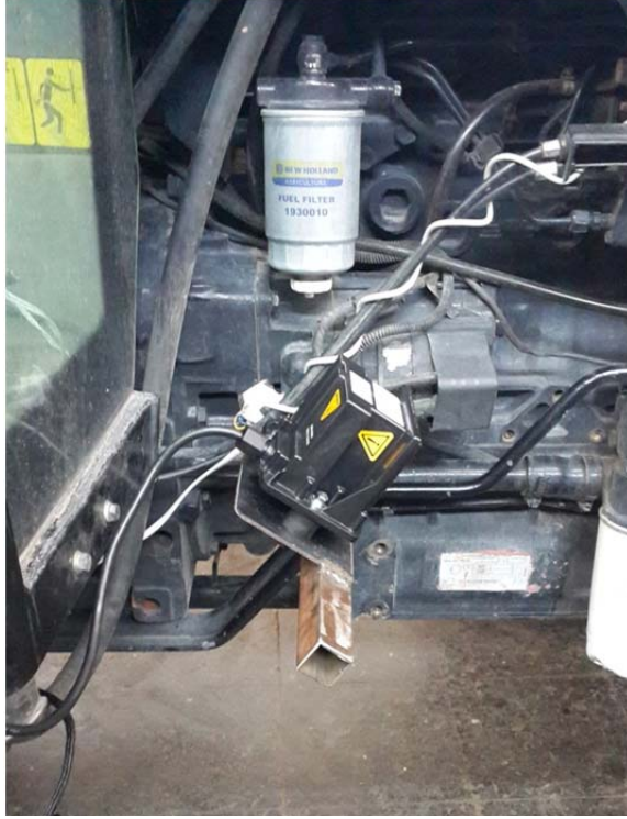
Şekil 3.9. Denemeler sırasında kullanılan Dickey John marka Radar III model dopler radar hız sensörünün traktör çatısına konumlandırılmış şekli
