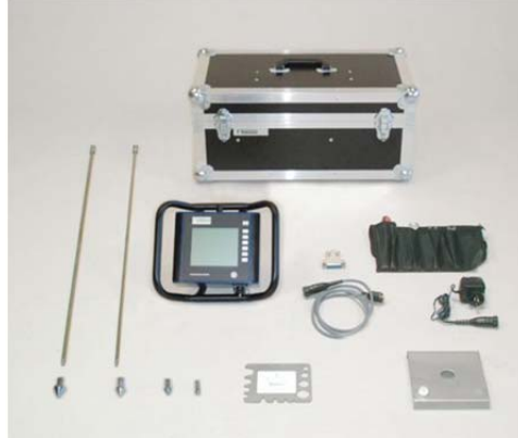
Şekil 3.11. Eijkelkamp marka dijital el penetrometresinin genel görünüşü
