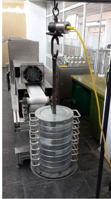
Şekil 4.1. Çeki pimleri kalibrasyon düzeneği
