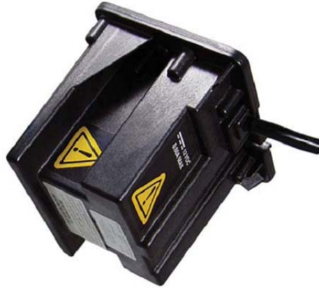
Şekil 3.7. Denemeler sırasında ilerleme hızını ölçmek için kullanılan Dickey John marka Radar III model dopler radar hız sensörü
