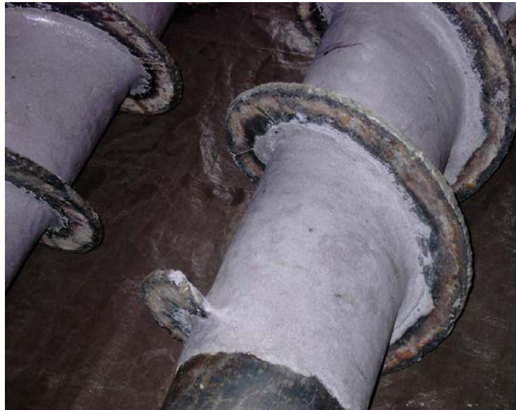
Şekil 1.9 : Madenlerde kullanılan ve abrasif aşınmaya maruz kalmış toprak kazıcı [7].
