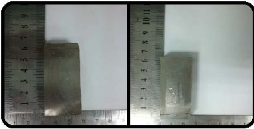
Şekil 5.34 : Tasarım 5 numunesinin aşınma testi öncesi ve sonrası üst yüzey görüntüsü
