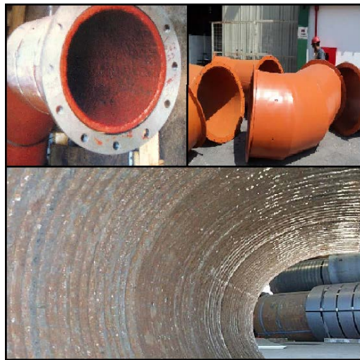
Şekil 2.13 : İletim sistemlerinde aşınma plakalarının kullanıldığı iş parçaları
