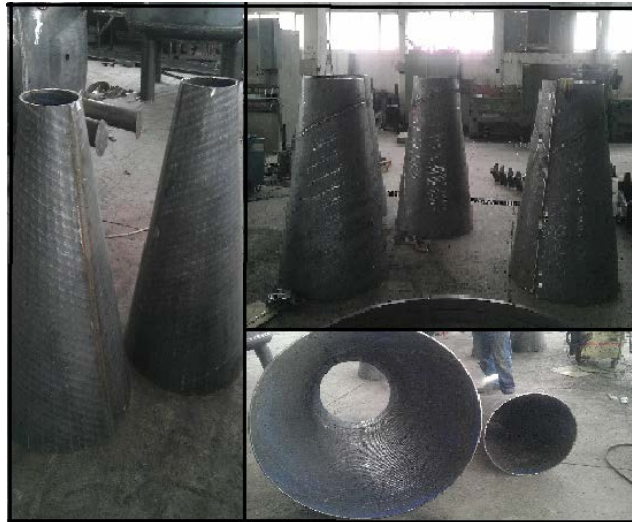
Şekil 2.15 : Aşınma plakalarının bükülerek kullanıma hazır şekli
