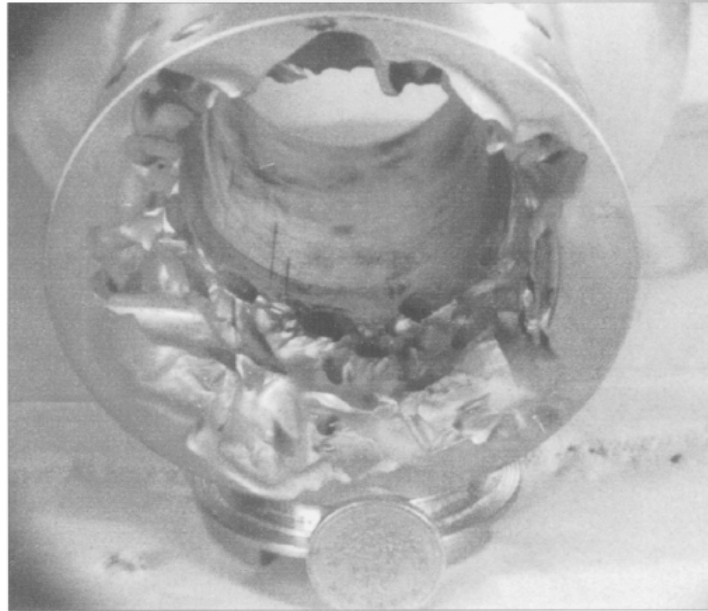
Şekil 1.19 : Yüksek hızlı akışkan içerisindeki sert parçacıkların neden olduğu erozyon aşınması [5].
