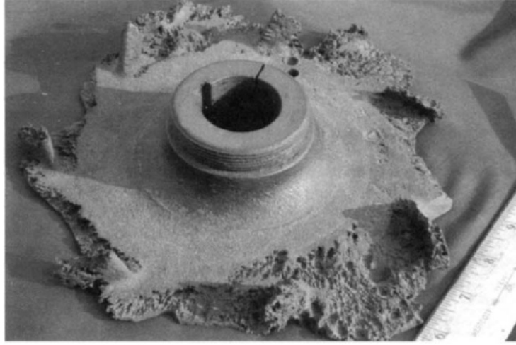
Şekil 1.20 : Su besleme pompasının pervanesinde meydana gelen kavitasyon aşınması [1].
