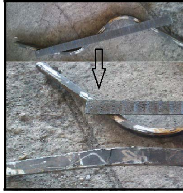
Şekil 2.19 : Demiryolu hat değışim noktalarında kullanılan aşınma plakası parçaları
