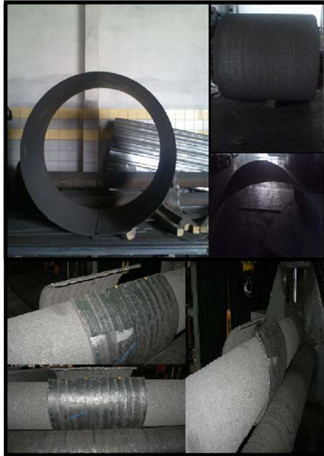
Şekil 4.7 : Aşınma plakasının düzleştirme işlemi anının, öncesinin ve sonrasın görüntüsü
