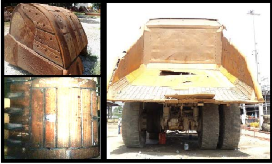
Şekil 2.12 : Madencilikte aşınma plakalarının kullanıldığı iş parçaları
