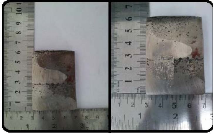
Şekil 5.13 : Tasarım 2 numunesinin aşınma testi öncesi ve sonrası üst yüzey görüntüsü
