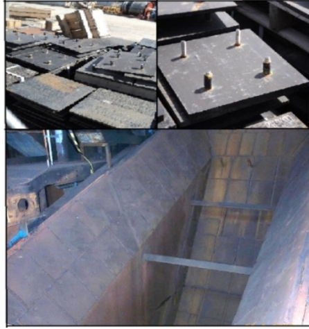
Şekil 2.16 : Aşınma plakalarının bunkerlerde kullanımının görüntüsü
