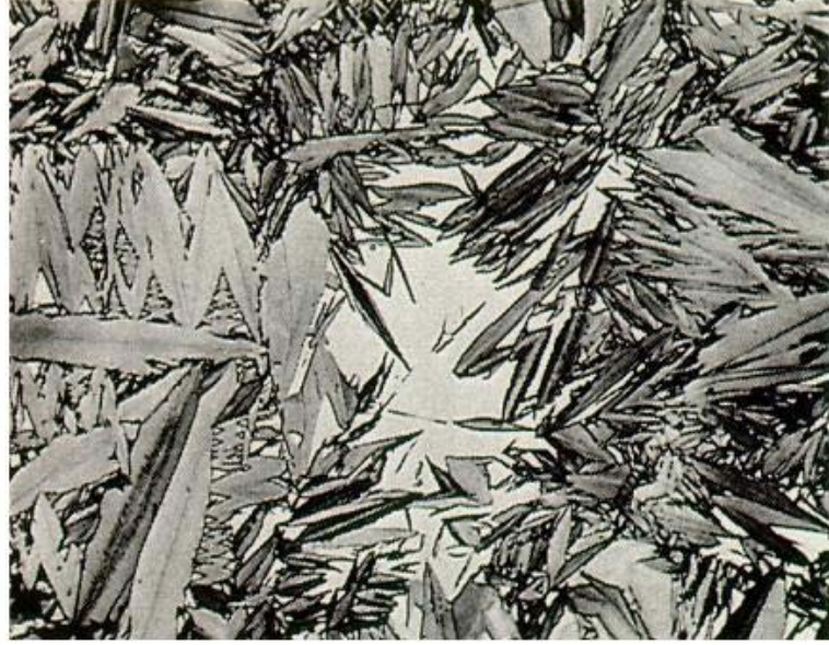
Şekil 2.4 : Martensitik bir alaşım mikro yapı görüntüsü [15].
