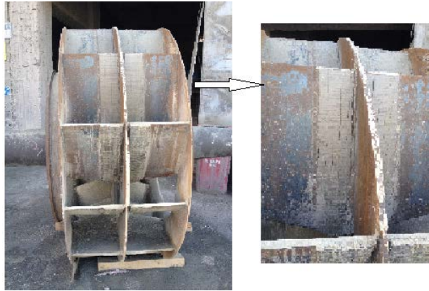
Şekil 2.17 : Çimento sanayisinde toz tutucularda kullanılan aşınma plakalarının görüntüsü
