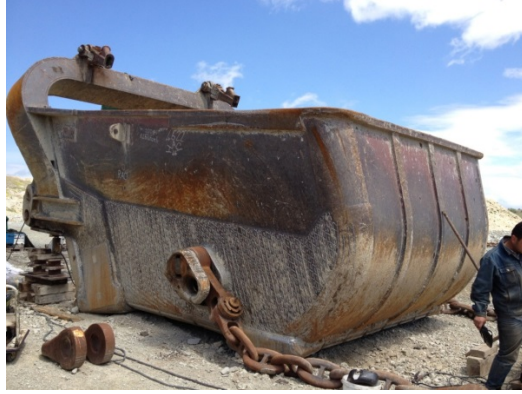
Şekil 1.13 : Yoğun abrasif aşınma etkisine maruz kalmış iş makinası kovasının görüntüsü.
