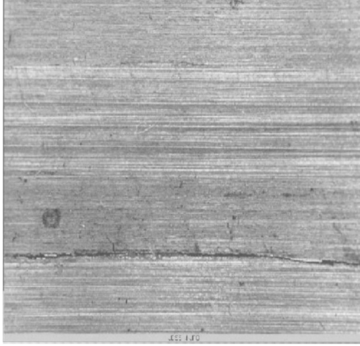
Şekil 1.7 : Malzemeler arasında sıkışan sert parçacıkların neden olduğu abrasif aşınma [5].
