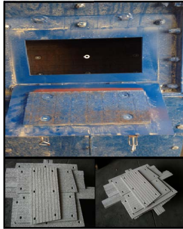
Şekil 2.20 : Kırık cam dökölen bunkerlerde aşınma plakalarının kullanımı
