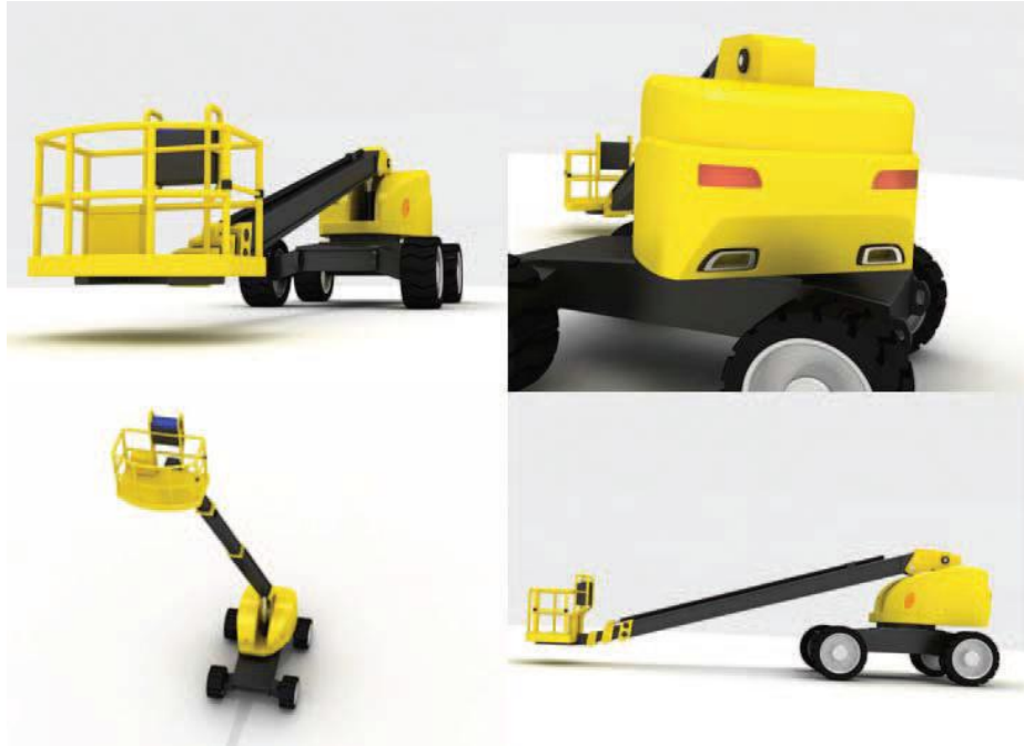
Şekil 2.1 Araç üstü mobil hidrolik platform modelleme ve konsept tasarımı (Junve ark. 2011)
