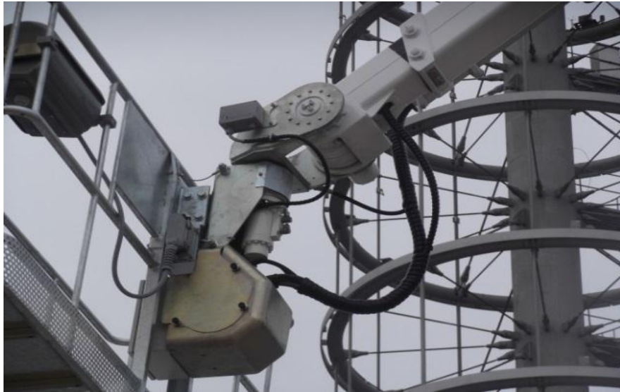
Şekil 2.15 Bronto sepet dengeleme sistemi
