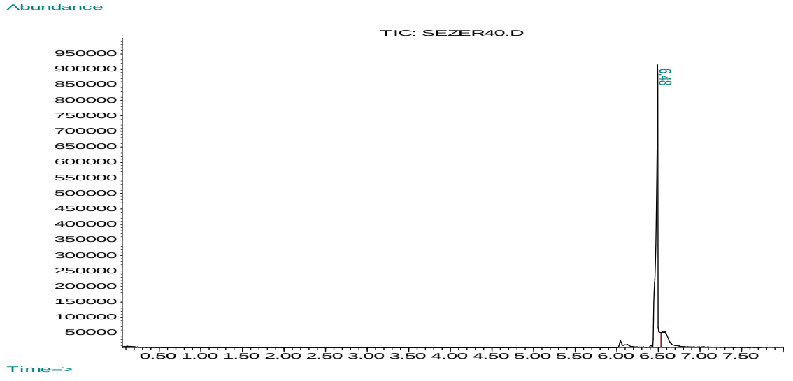
NÇA'dan elde edilen etanolün gaz kromatogramı
