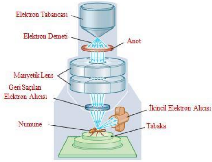
Şekil 2.21. Taramalı elektron mikroskobunun şematik görünümü (Anonymous 2014b)
