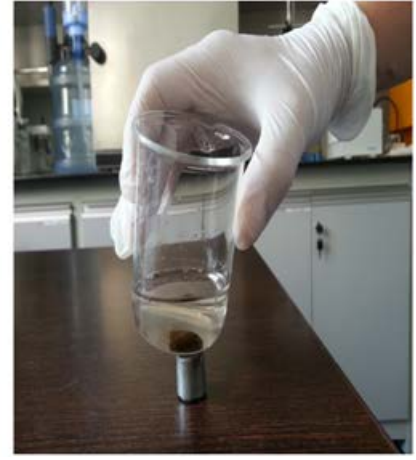
Şekil 5.3. Manyetik biyosorbanların mıknatıs yardımıyla ayrılması
