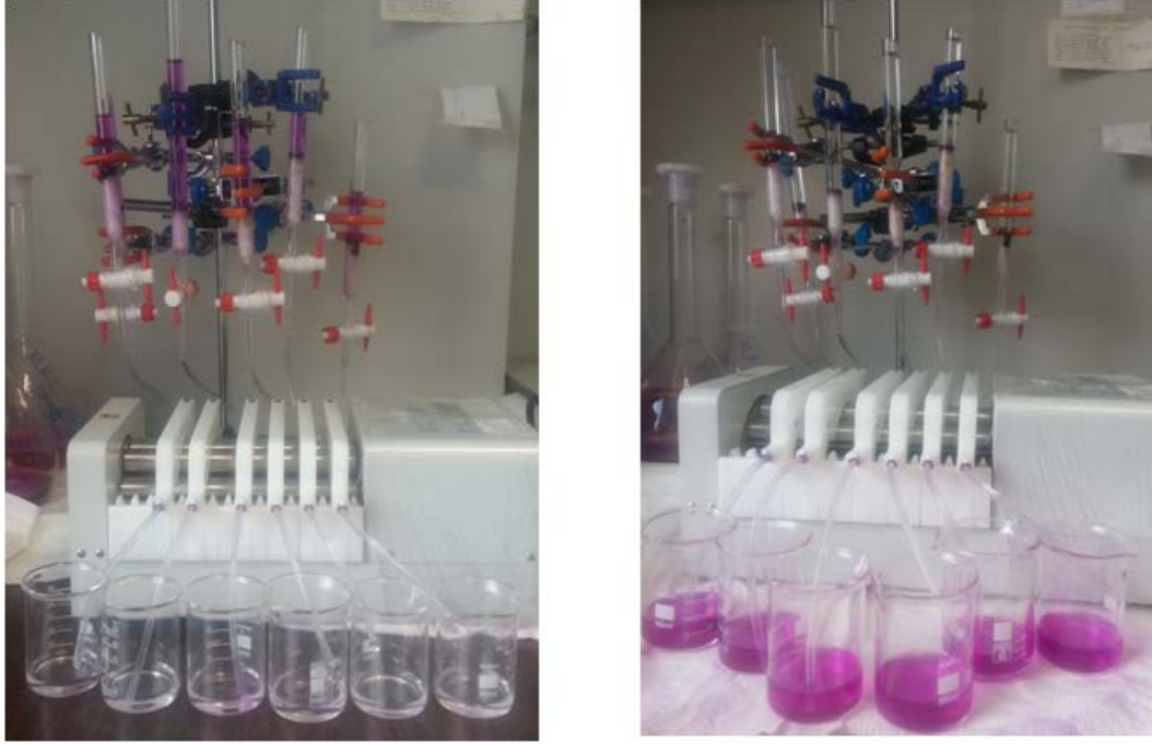
Şekil 5.4. İmmobilize biyosorban ile RV1 boyarmaddesinin sürekli sistemde biyosorpsiyon–desorpsiyon çalışması
