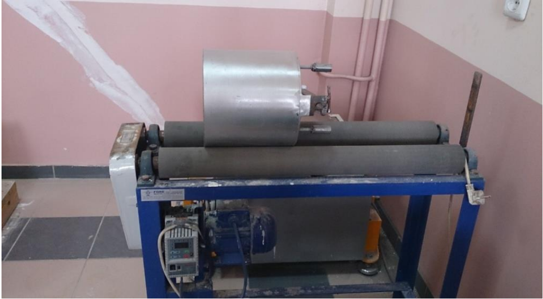
Resim 5.3. Deneyleerde kullanılan bilyeli değirmenin genel görünüşü
