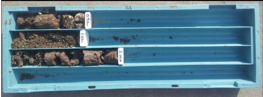
Şekil 6.13 : SK3 sondajına ait karot sandık fotoğrafı.
