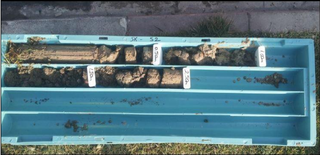
Şekil 6.11 : SK2 sondajına ait karot sandık fotoğrafı.
