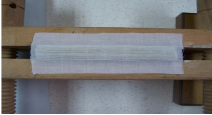
Şekil 56. Bezin yapıştırılıp kurumaya bırakılması (Bora, 2012, s. 159).
