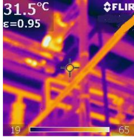
Şekil 2.47 İzolasyonsuz borularda ısı kayıpları
