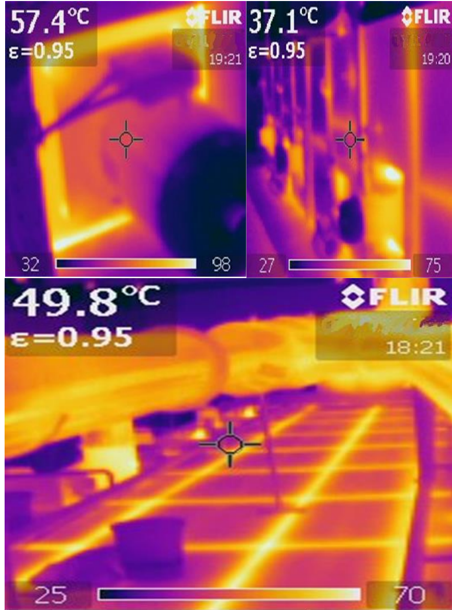
Şekil 2.20 Tekstil kurutma makinasında termal kamera ile çekilen yan ve motor görüntüsü
