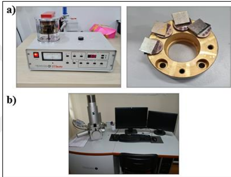
Şekil 3.7. a) Cressington Sputter Coater 108 Auto altın kaplama makinesi ve b) Tescan Vega3 SEM cihazı
