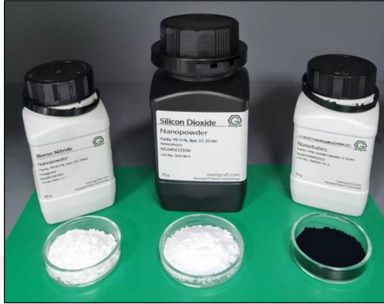
Şekil 3.1. Epoksi yapıştırıcıya takviye edilen nano malzemeler
