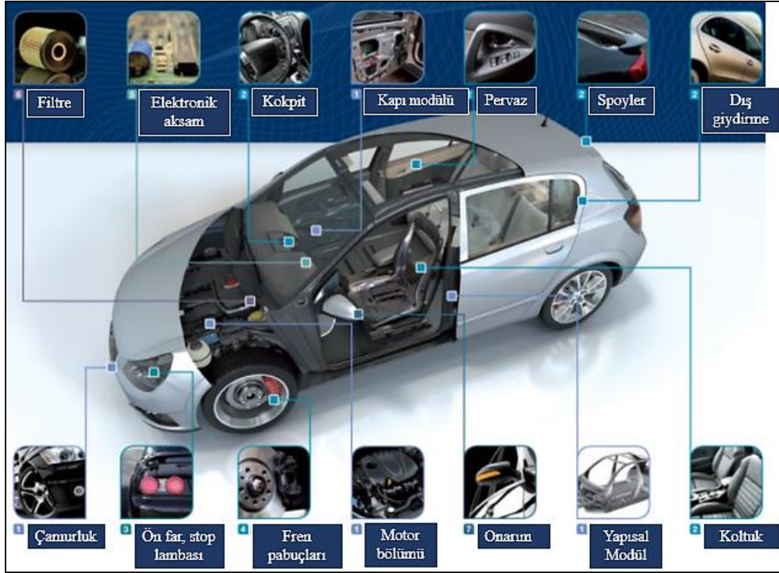
Şekil 2.5. Otomobillerde kullanılan yapıştırma bağlantısı bölgeleri (URL-5)
