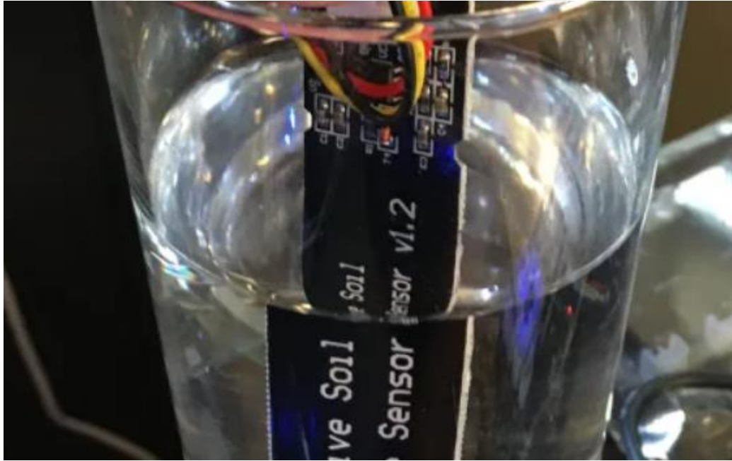
Şekil 4.4. Kapasitif toprak nem sensörü kalibrasyon ayarının yapılması
