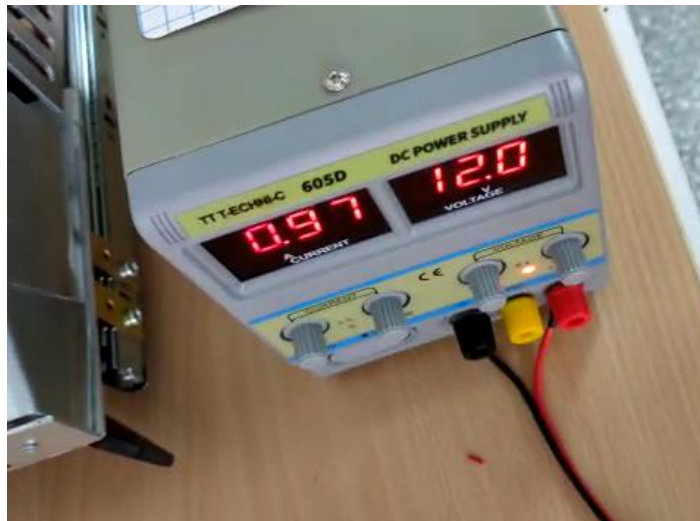
Şekil 4.3. Devrenin çalışma akım ve gerilim değerleri
