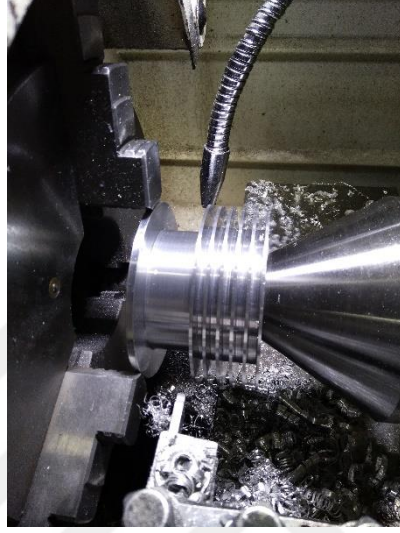
Şekil 4.14. Silindir peteklerinin kesme kateri ile işlenmesi
