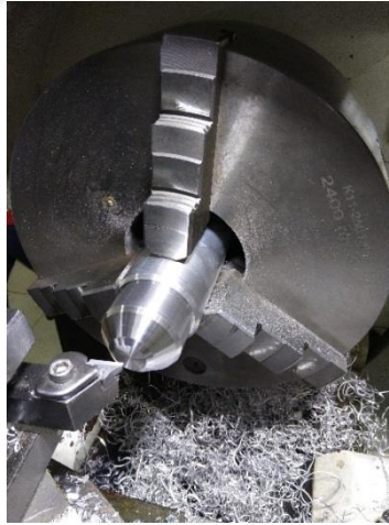
Şekil 4.74. Egzozun burun kısmının torna edilmesi
