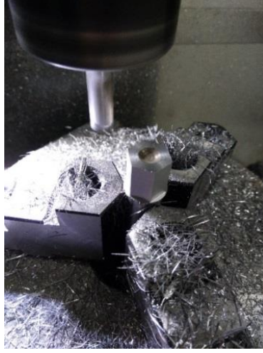
Şekil 4.87. Somunun altıgen olarak işlenmesi
