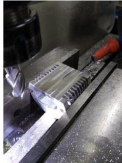
Şekil 4.84. Tarama yapılmış manifold yüzeyi
