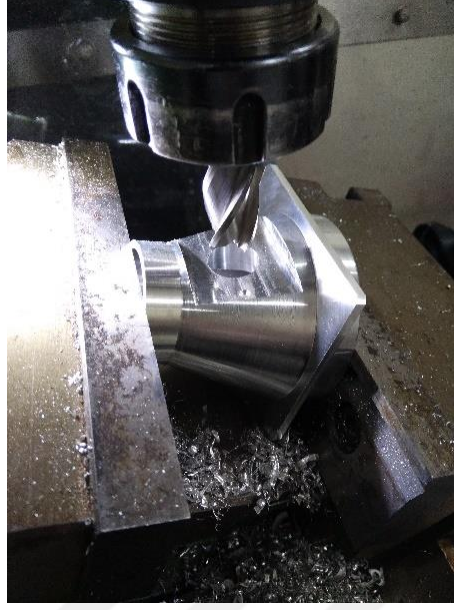
Şekil 4.42. Emme manifold girişinin açılması
