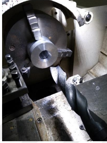
Şekil 4.12. Silindirin gömlek yatağının tornada matkap yardımı ile delinmesi
