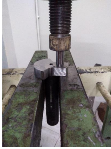
Şekil 4.55. Krank kolunun hidrolik preste çakılması
