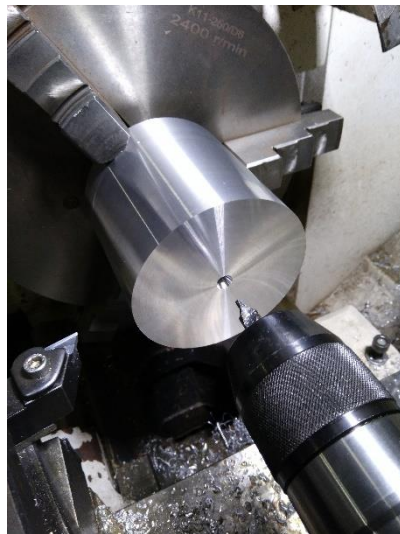
Şekil 4.4. Punta deliğinin, punta matkabı yardımı ile tornada açılması
