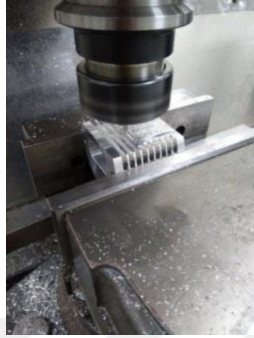
Şekil 4.85. Parmak freze ile kanalların açılması
