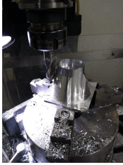
Şekil 4.44. Freze tezgâhında burun kısmının işlenmesi
