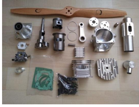
Şekil 4.98. Uçak motorunu oluşturan parçalar
