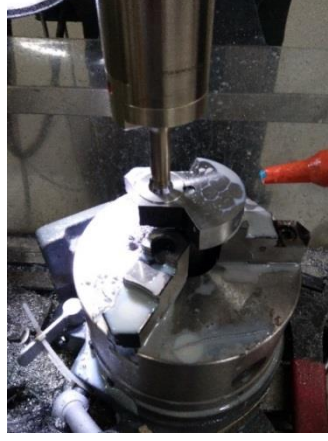
Şekil 4.53. Krank kolunun yuvasının frezede delinmesi
