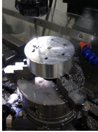
Şekil 4.25. Silindir kapağının saplama deliklerinin divizör yardımı ile delinmesi
