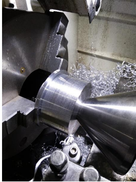
Şekil 4.39. Punta desteği ile parçanın işlenmesi
