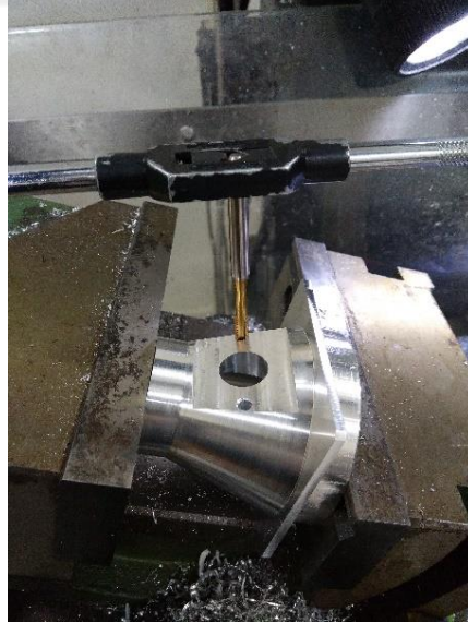
Şekil 4.43. Manifold saplama yuvalarına kılavuz ile diş açılması
