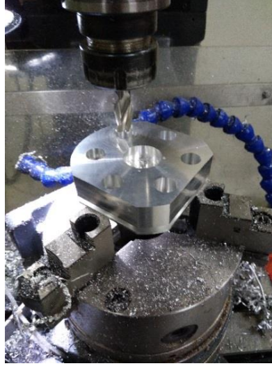
Şekil 4.33. Saplama yuvalarının parmak freze ile açılması
