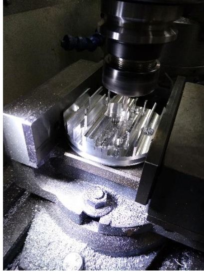
Şekil 4.34. Soğutma kanallarının parmak freze ile açılması
