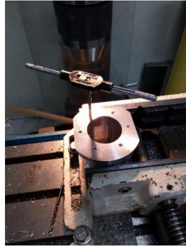
Şekil 4.19. Silindir saplama yuvalarına diş çekilmesi
