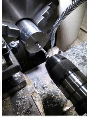
Şekil 4.51. Dönel valfli emme manifold deliğinin tornada açılması
