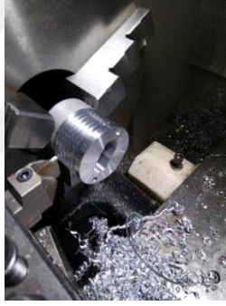
Şekil 4.83. Soğutma peteklerinin tornada açılması
