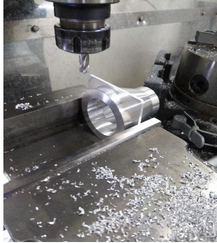
Şekil 4.41. Parmak freze ile tıraşlanmış parça
