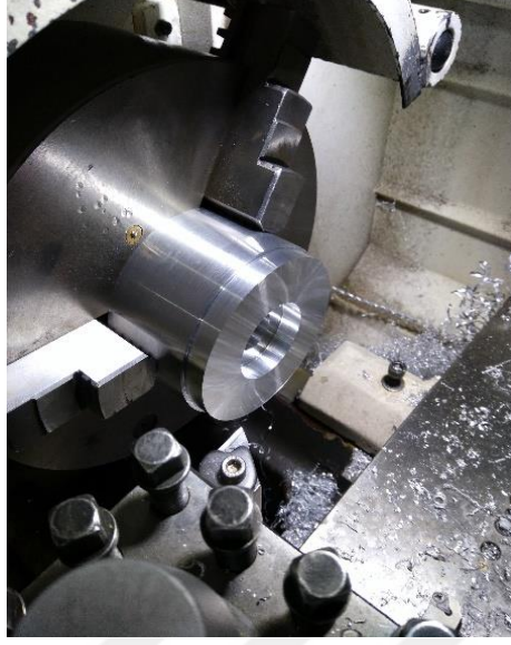
Şekil 4.38. Karter faturasının torna edilerek yapılması
