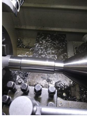
Şekil 4.73. Dış yüzeyi torna edilmiş egzoz
