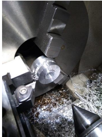
Şekil 4.90. Pervane burcunu işlenmesi
