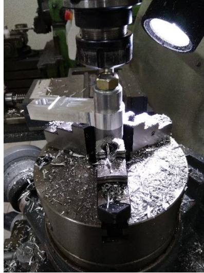
Şekil 4.67. Biyel kolunun alt ve üst kısımlarının dairesel olarak işlenmesi
