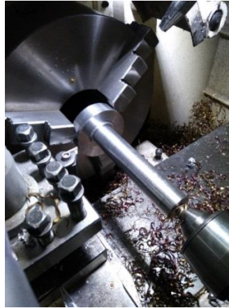
Şekil 4.52. Rulman yataklarının kaba ölçü ile işlenmesi
