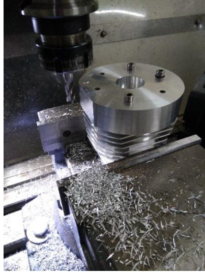
Şekil 4.32. Silindir kapağını tıraşlanması
