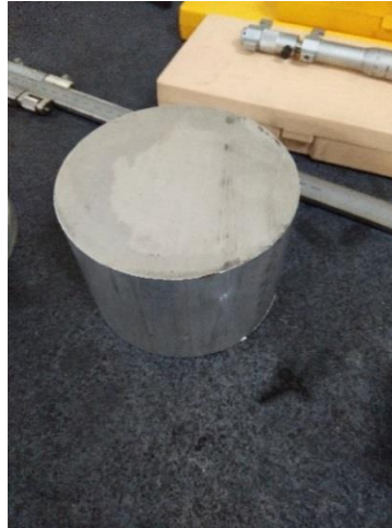
Şekil 4.11. Silindir imalatında kullanılan kütük çekme alüminyum malzeme
