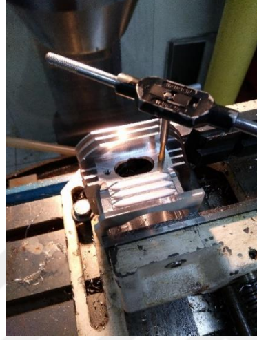
Şekil 4.18. Egzoz saplama yuvalarına diş çekilmesi
