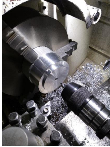
Şekil 4.23. Silindir kapağına punta deliğinin açılması
