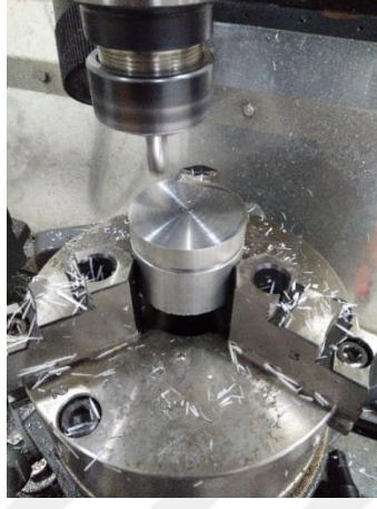
Şekil 4.96. Emme manifoldunu frezede işlenmesi
