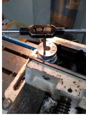
Şekil 4.91. Pervane burcuna diş çekilmesi
