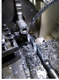
Şekil 4.71. Egzozun torna tezgâhında delinmesi
