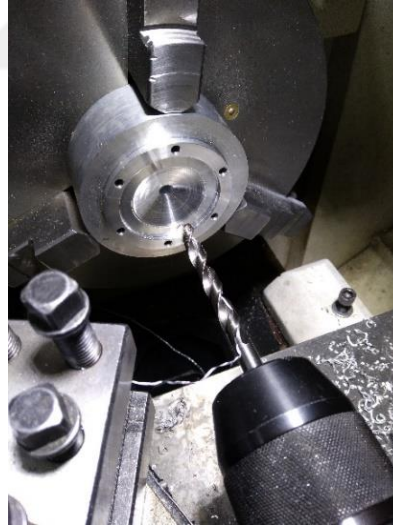
Şekil 4.27. Buji yuvasının matkap yardımı ile tornada delinmesi
