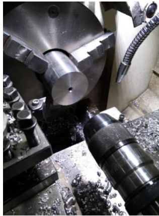
Şekil 4.50. Punta deliğinin tornada açılması
