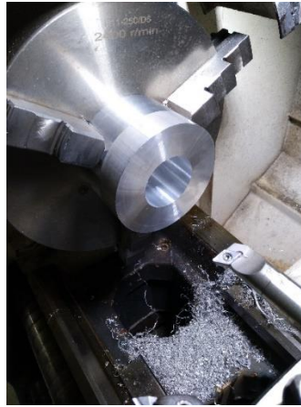
Şekil 4.13. Silindirin gömlek yatağının tornada delik kateri ile işlenmesi
