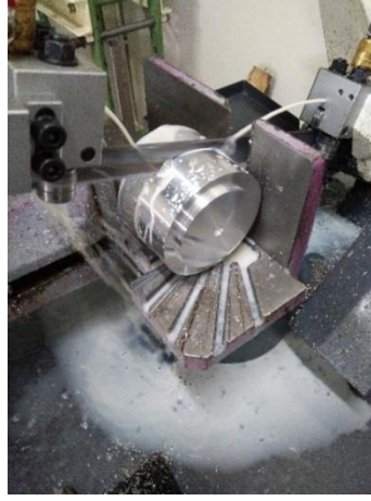
Şekil 4.24. Silindir kapağının şerit testerede kesilmesi
