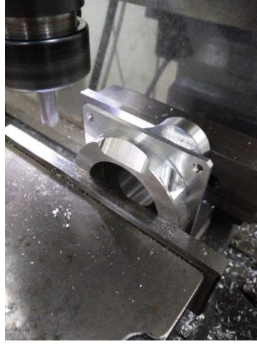
Şekil 4.46. Emme portlarını besleyen kanalın frezede açılması
