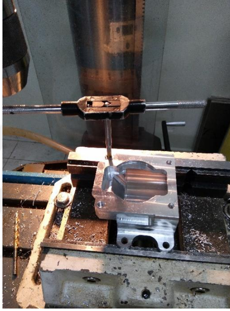
Şekil 4.9. Silindir saplamalarına ait vida yataklarının kılavuz yardımı ile açılması
