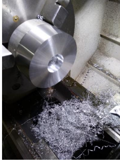
Şekil 4.37. Rulman yatağının delik kateri ile işlenmesi
