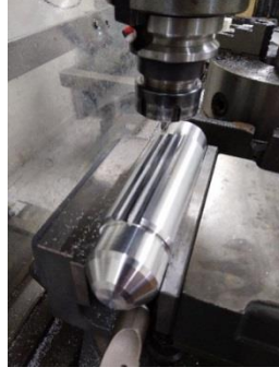
Şekil 4.75. Soğutma peteklerinin frezede açılması
