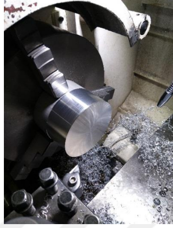
Şekil 4.22. Referans yüzeyleri oluşturulmuş parça
