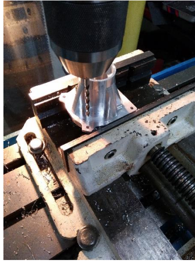
Şekil 4.45. Matkap tezgâhında montaj deliklerinin delinmesi
