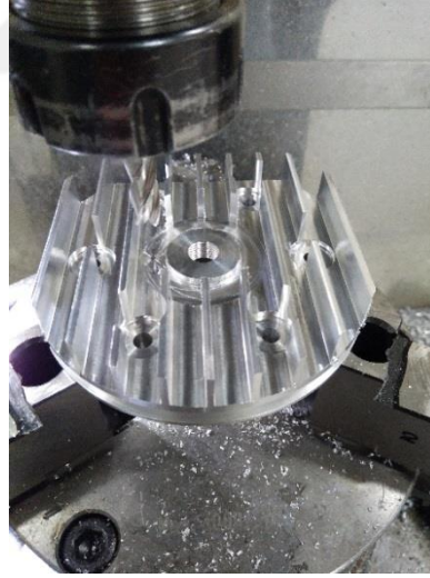
Şekil 4.35. Buji yuvasının dairesel olarak divizör yardımı ile işlenmesi
