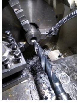
Şekil 4.59. Gmlek malzemesinin tornada delinmesi
