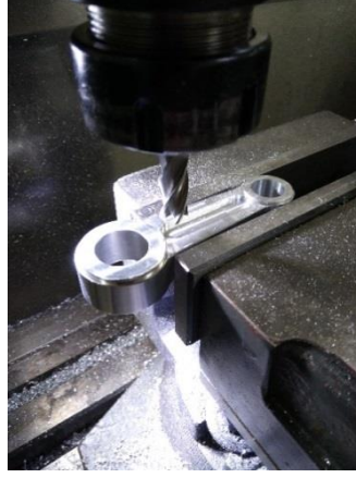
Şekil 4.68. Göbek kısmı frezelenmiş biyel kolu
