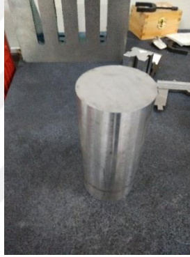
Şekil 4.49. Isıl işlemle sertleştirilebilir krom alaşımli çelik malzeme
