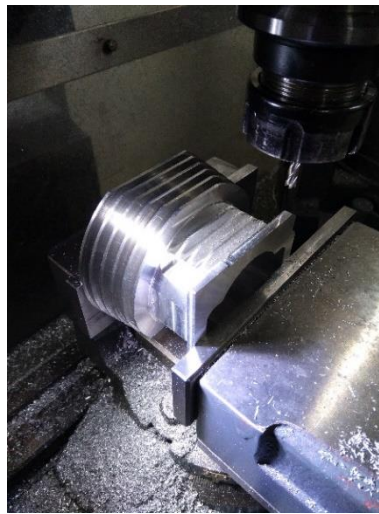
Şekil 4.17. Parmak freze yardımı ile peteklerin açılması
