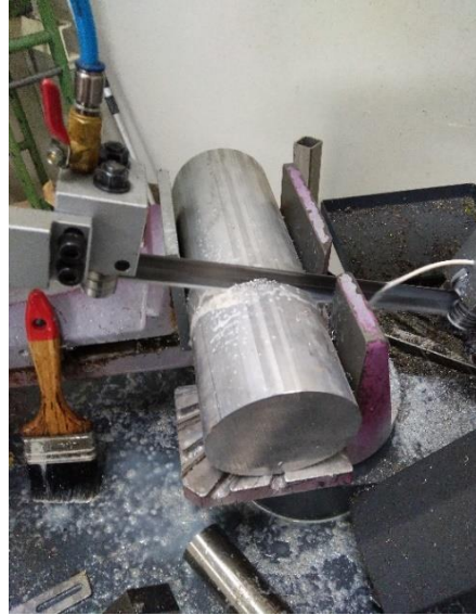
Şekil 4.2. Karter malzemesinin kaba ölçüde kütük malzemedен kesilmesi
