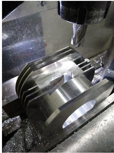
Şekil 4.15. Silindir üzerindeki egzoz portunun freze ile açılması
