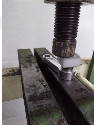
Şekil 4.69. Biyel kolu rulmanlarının preste çakılması
