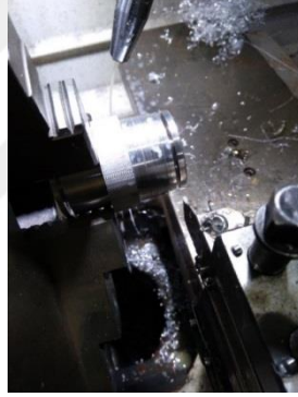
Şekil 4.94. Pervane flanşının kesme kalemii ile kesilmesi
