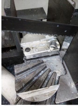
Şekil 4.66. Fazlalıkların şerit testerede kesilme işlemi
