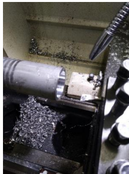
Şekil 4.72. Egzozun tapa kısmının torna edilmesi
