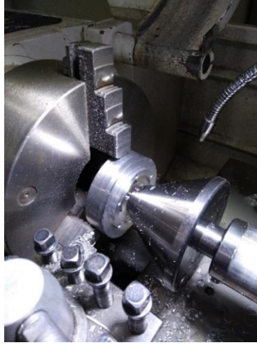
Şekil 4.31. Bor yağı kullanılarak tornada kesme kateri ile kanal açılması
