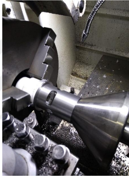
Şekil 4.62. Gömleğin dış çapının malafa desteği ile torna edilmesi
