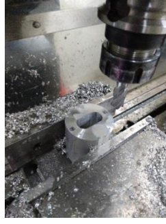
Şekil 4.82. Manifold yuvasının açılması
