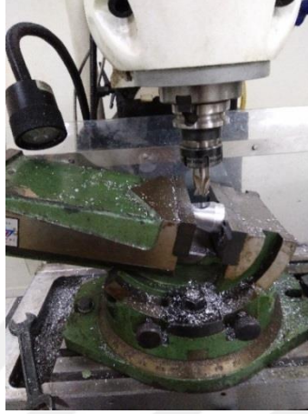
Şekil 4.78. Açılı mengene ile delme işlemi
