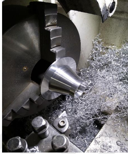
Şekil 4.40. Konik çekme işlemi yapılmış parça
