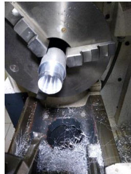
Şekil 4.77. Egzoz tapasının konik olarak işlenmesi
