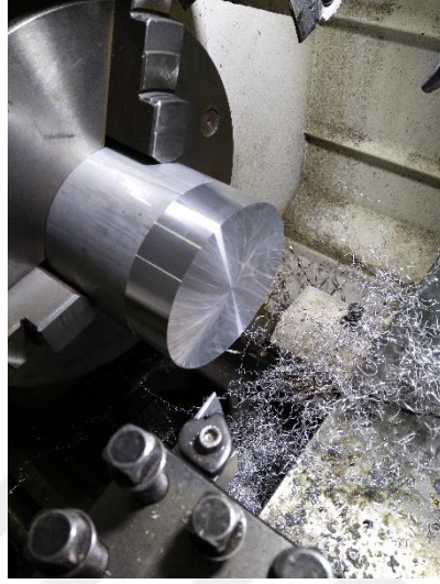
Şekil 4.3. Referans yüzeylerinin torna edilmesi
