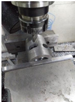
Şekil 4.61. Gmlek portlarının frezede aılması
