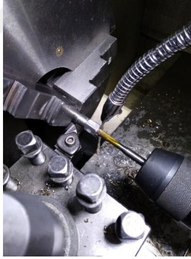
Şekil 4.88. Pervane somununa diş çekilmesi
