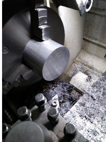
Şekil 4.21. Kesimi yapılan malzemenin tornaya bađlanması
