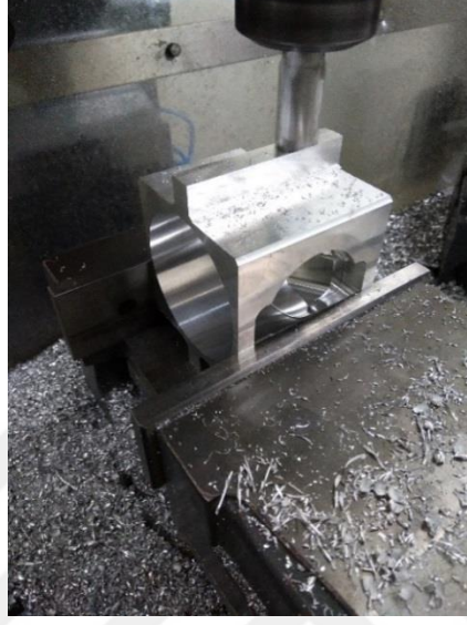
Şekil 4.7. Motor kulaklarının frezelenmesi
