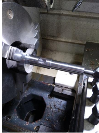
Şekil 4.56. Krank rulman yataklarının tornada işlenmesi
