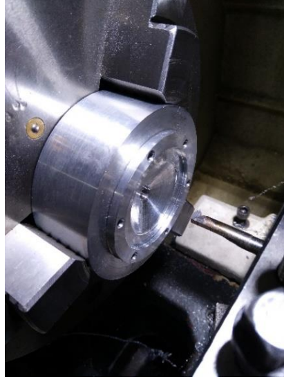
Şekil 4.28. Buji yuvasının iç diş kalemi ile tornada açılması
