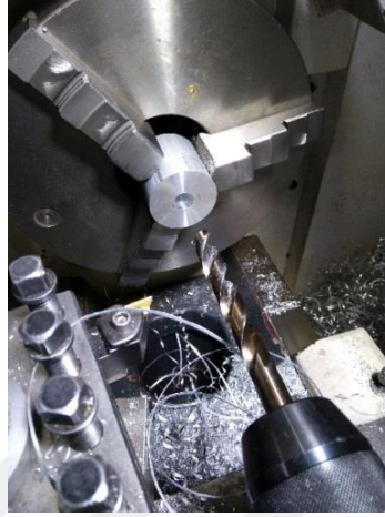
Şekil 4.80. Manifold kılavuz deliğinin açılması
