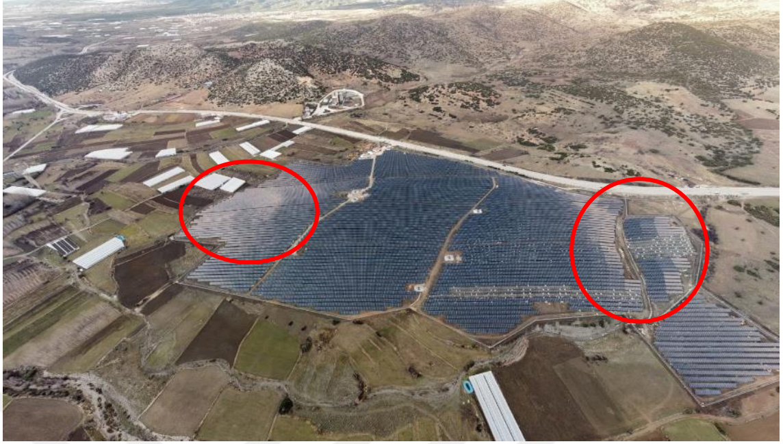
Şekil 2.5. Çalışma Sahası olan FERNAS-4 GES'in drone ile çekilmiş görüntüsü ve su yüzeyine benzer yansımalar
