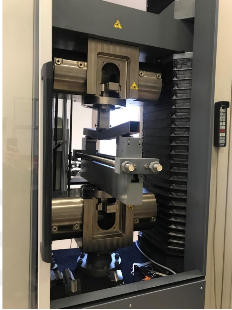
Şekil 4. 13 Lam malzeme için deney düzeneği
