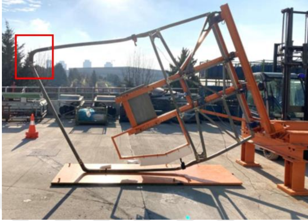
Şekil 4. 24 Devrilme sonrası kaynak hatası görülen bölge
