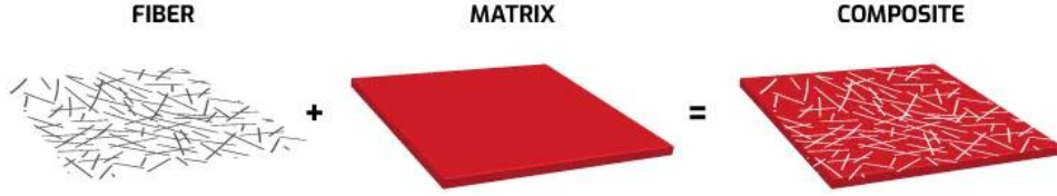
Şekil 3. 1 Kompozit malzeme yapısı[22]
