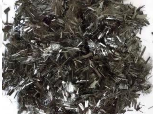
Şekil 3. 2 Kırpılmış karbon lif [24]
