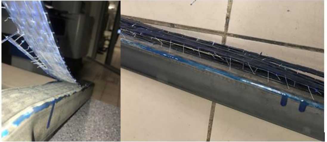
Şekil 4. 10 Test öncesi veya test sırasında FIB malzeme kaynaklı hata sebebiyle değerlendirilmeye alınmayan numune örnekleri
