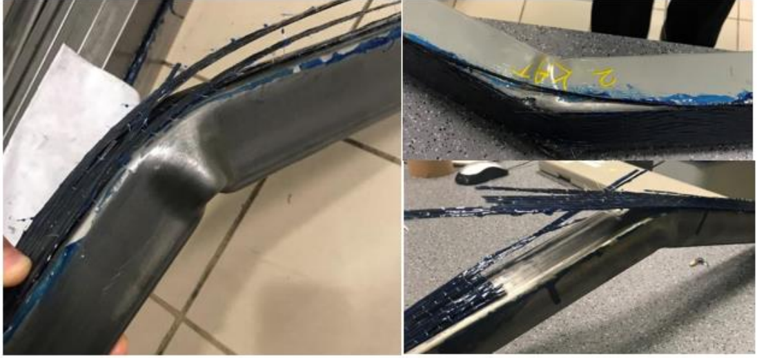
Şekil 4. 9 Test sonrası profillerin görüntüleri
