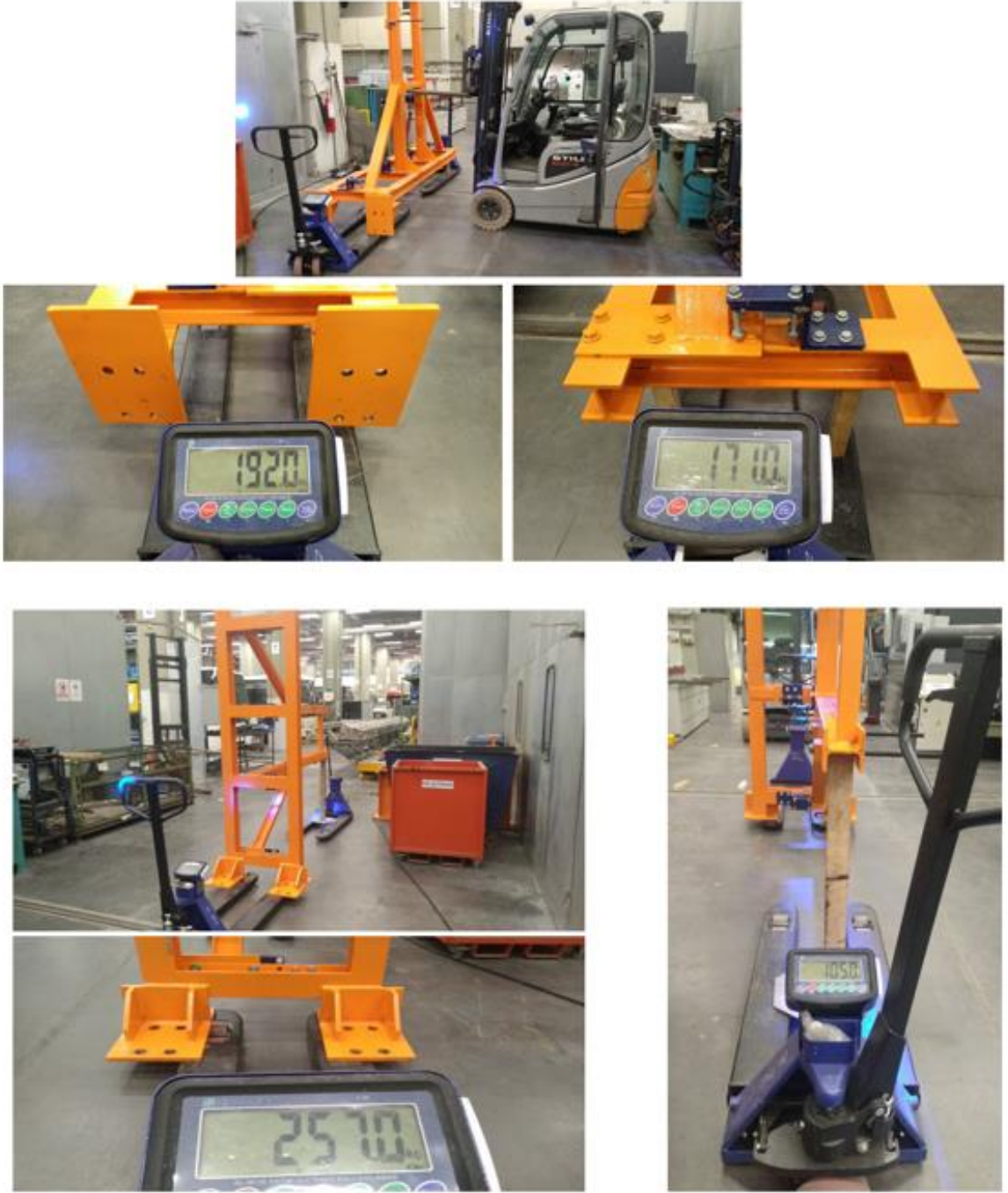
Şekil 4. 16 Tezgah parçalarının ölçümü
