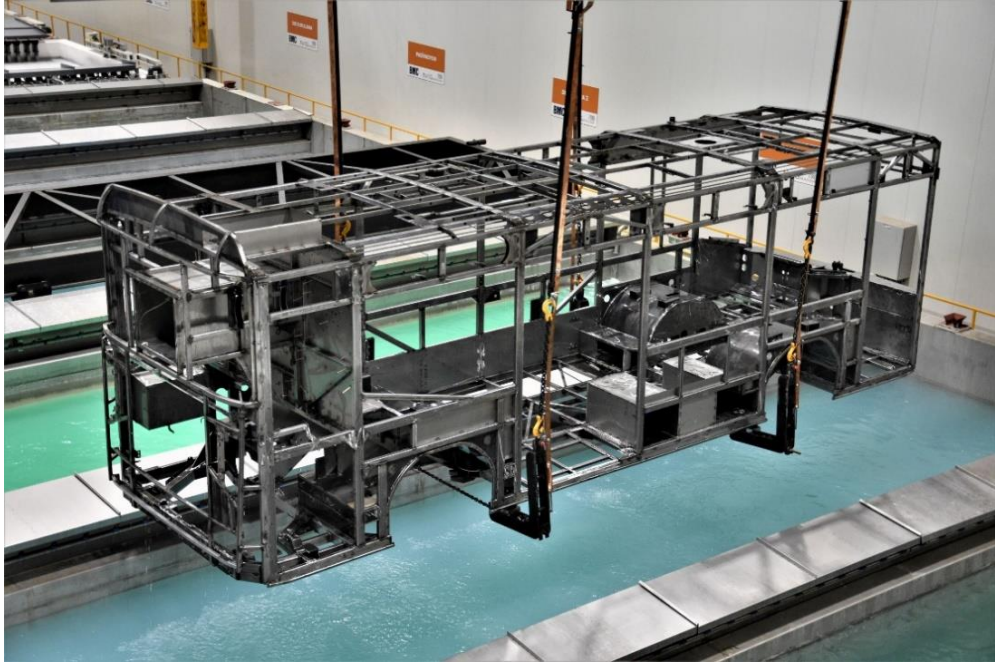
Şekil 4. 5 KTL havuzuna daldırılan bir otobüs karoserisi [30]
