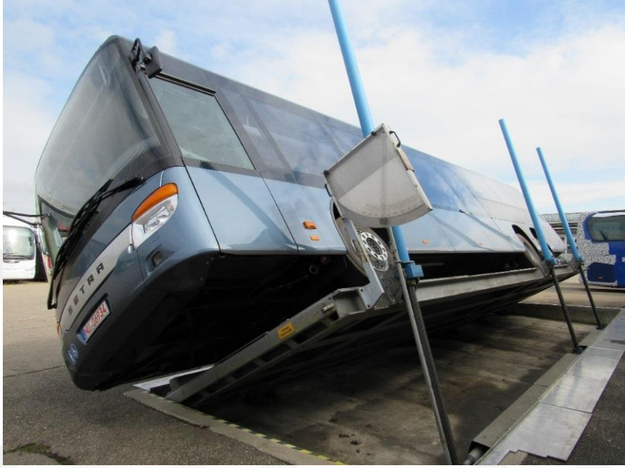
Şekil 2. 8 Test öncesi araç dışı hazırlık
