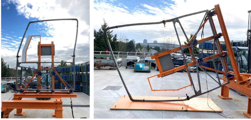
Şekil 4. 28 1 numaralı takviyesiz yapının devrilme testi
