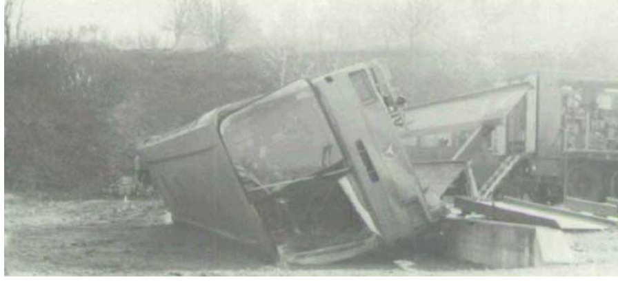
Şekil 2. 2 Mercedes-Benz O303 model otobüs devrilme testi [18]
