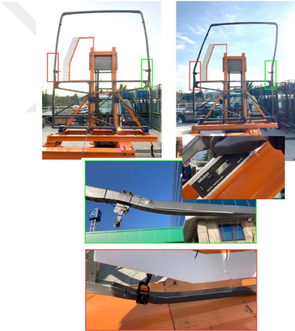
Şekil 4. 31 6 numaralı takviyeli yapının devrilme testi
