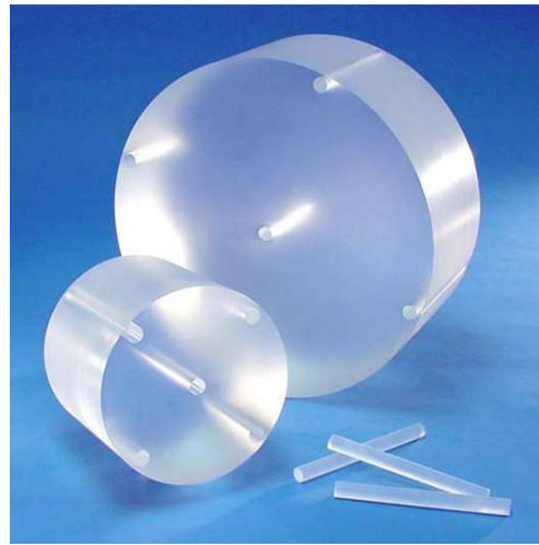
Şekil 2.14. Standart kafa ve vücut fantomu. Kafa fantomunun silindir çapı 16 cm, vücut fantomunun silindir çapı ise 32 cm’dir
