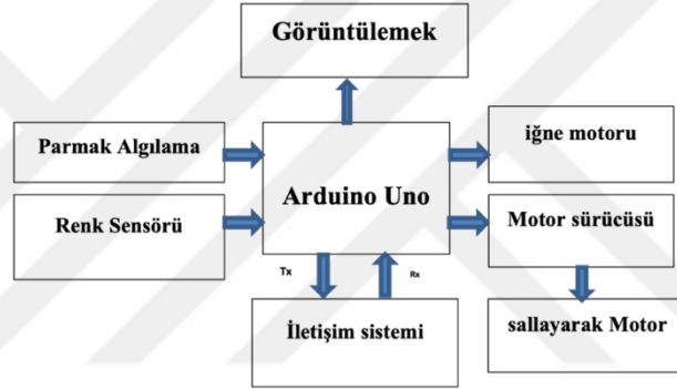
Şekil 4.12 Tasarlanan algılama sisteminin blok şeması
