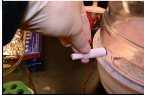
Şekil 3.8 Gazdan arındırma işleminde kullanılan vakumlu desikatör
