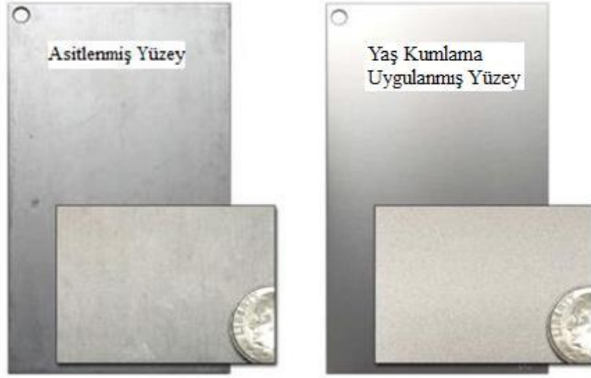
Şekil 2.10. Asitlenmiş ve yaş kumlama işlemi uygulanmış çelik yüzeyleri (Voges ve Mueth, 2008)
