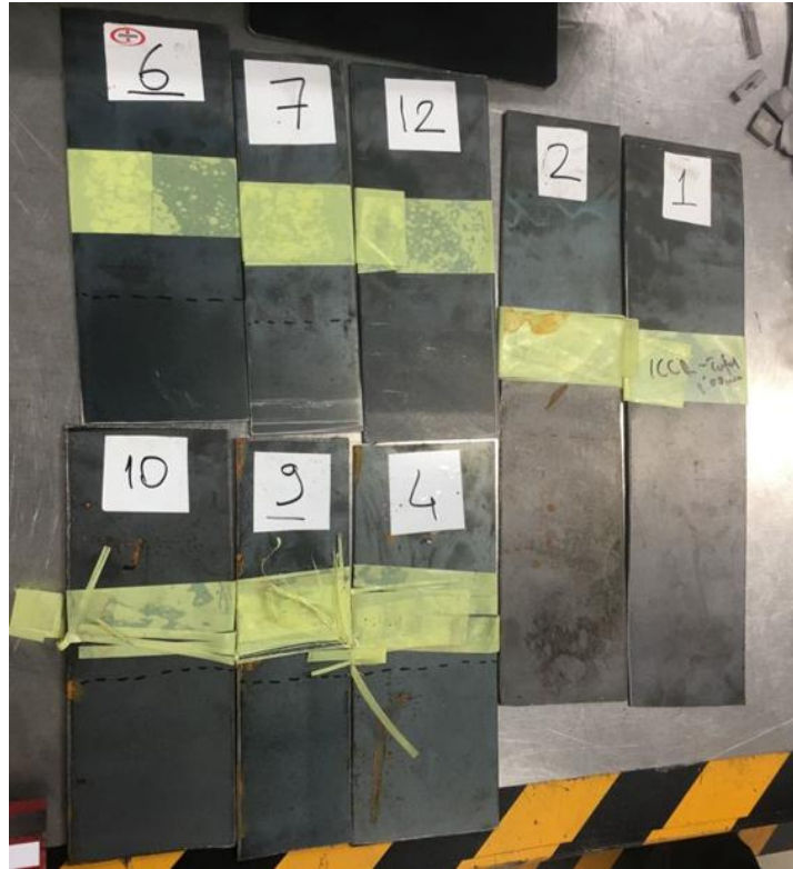
Şekil 3.13. Sabit parametreler ile kuru buz püskürtme işlemi uygulanmış numuneler
