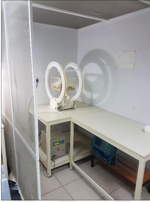
Şekil 3.6 Faraday kafes içerisinde sıçanlara uygulanan pulslu manyetik alan uygulama sisteminin genel görünümü.
