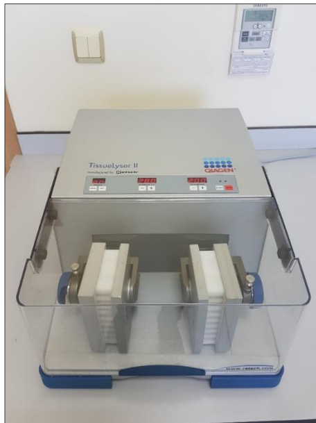
Şekil 3.15 Kas dokularının parçalanması için kullanılan doku parçalayıcı (sol) ve Trizol ile muamele sonrası homojenize olmuş kas dokusu (sağ).
