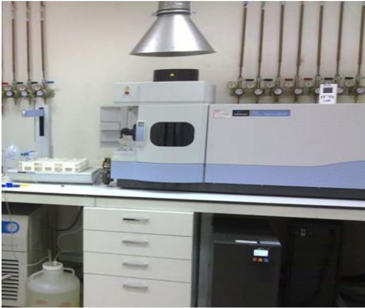
Şekil 3.8: ICP-OES cihazı (İndüktif Eşleşmiş Plazma Optik Emisyon Spektroskopisi, Perkin Elmer)
