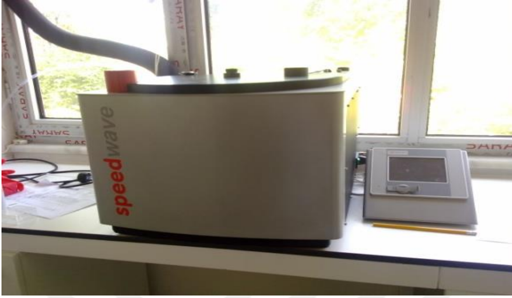
Şekil 3.5: Yaş yakma işlemi cihazı Berghof Mikrodalga
