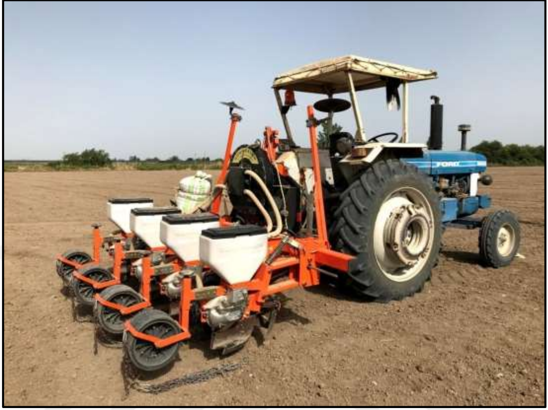
Şekil 3.5. Ekimde kullanılan pnömatik ekim makinesi, Burmahancı, Serik, Antalya
