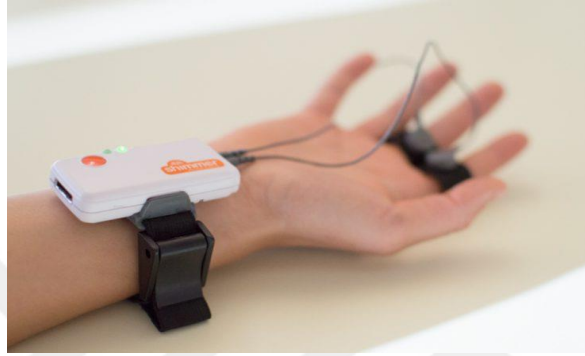
Resim 15: Galvanik Deri İletkenliği (GSR) cihazı
