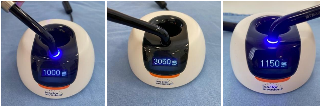
Şekil 17. Kullanılan ışık cihazlarının ve polimerizasyon modlarının ışık yoğunluğunun ölçümü (Sırasıyla A-B-C)
