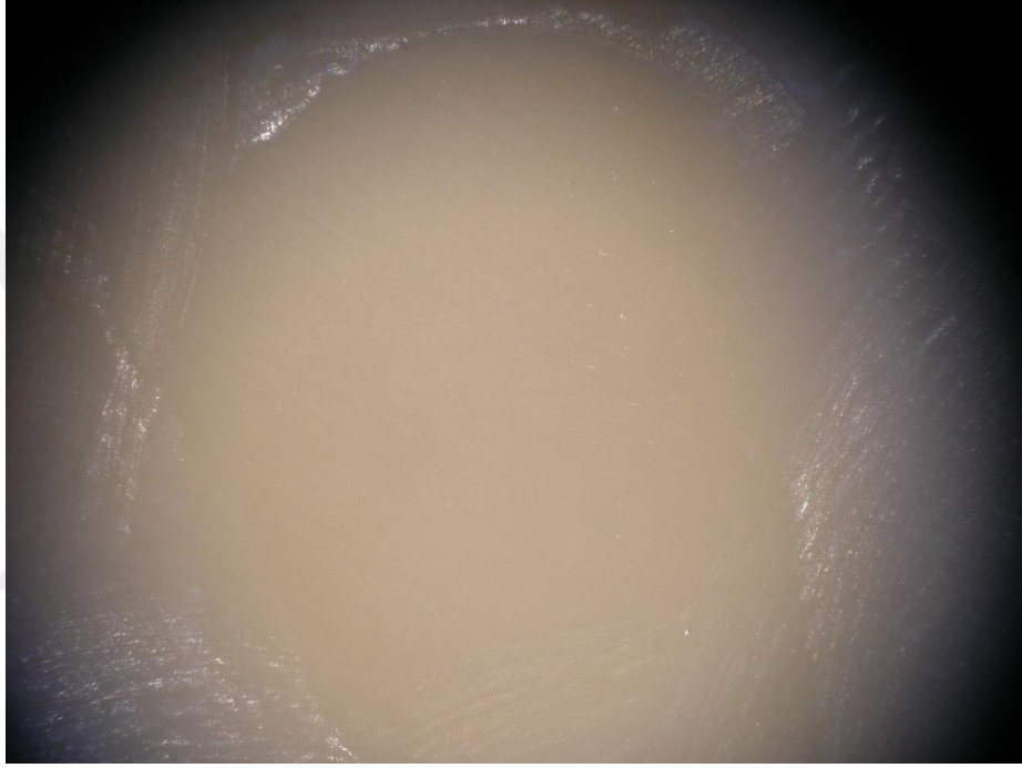
Şekil 23. Adeziv kırık tipi görülen rastgele seçilmiş bir örneğin x20 büyütmedeki stereomikroskop görüntüsü
