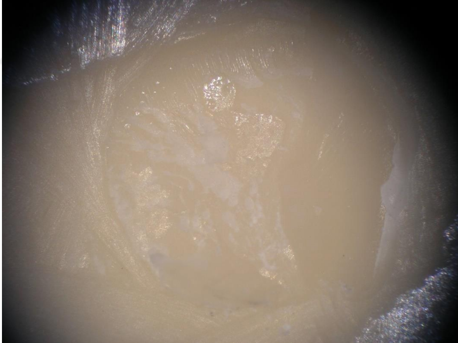
Şekil 25. Miks kırık tipi görülen rastgele seçilmiş bir örneğin x20 büyütmedeki stereomikroskop görüntüsü
