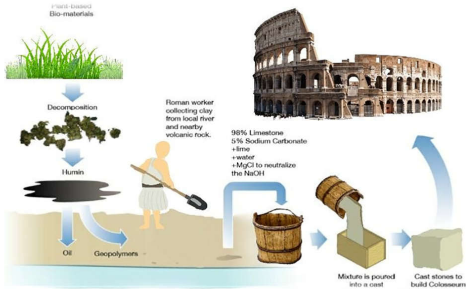
Şekil 1. Antik Roma'da geopolimer beton üretimi
