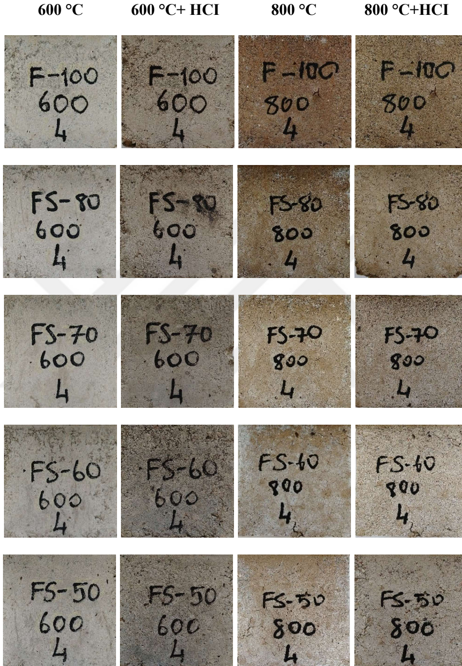
Şekil 51. 600°C+ HCl ve 800°C+ HCl sonrası numunelerin fiziksel görünümü
