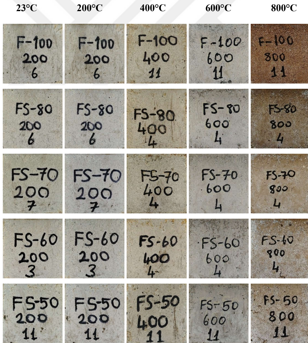
Şekil 46. Yüksek sıcaklık etkisi sonrası numunelerin fiziksel görünümü
