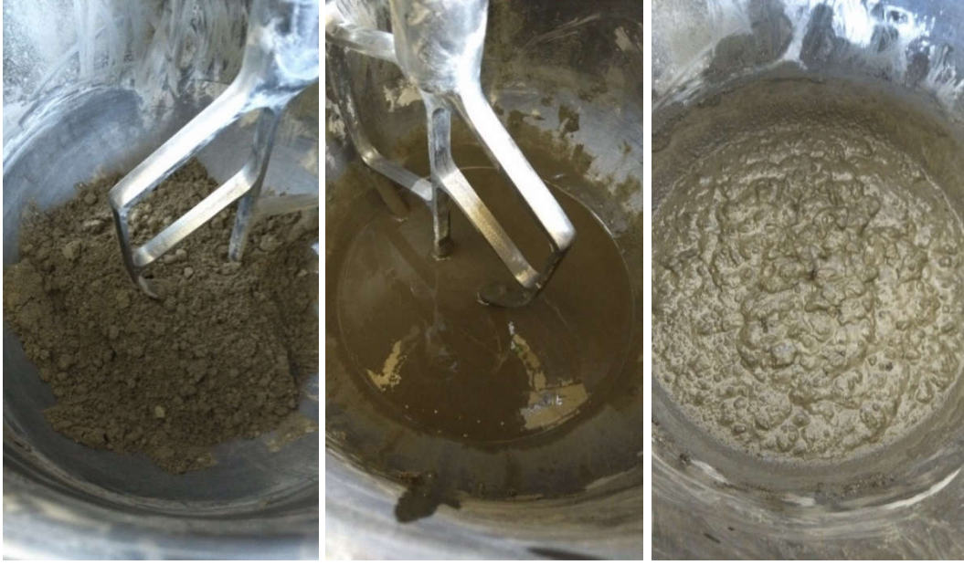
Şekil 33. Geopolimer beton karışımının üretilmesi
