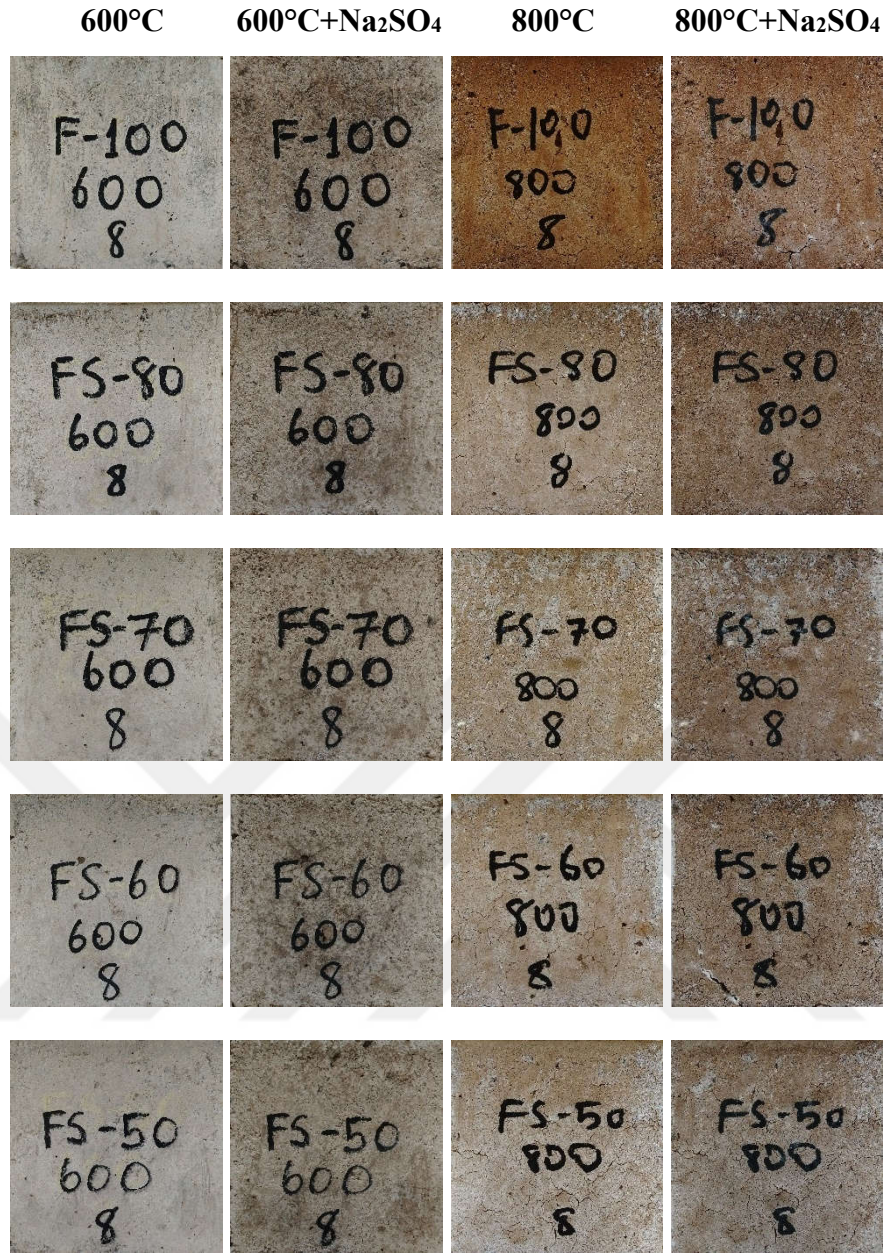
Şekil 56. 600°C+Na 2 SO 4 ve 800°C+ Na 2 SO 4 sonrası numunelerin fiziksel görünümü
