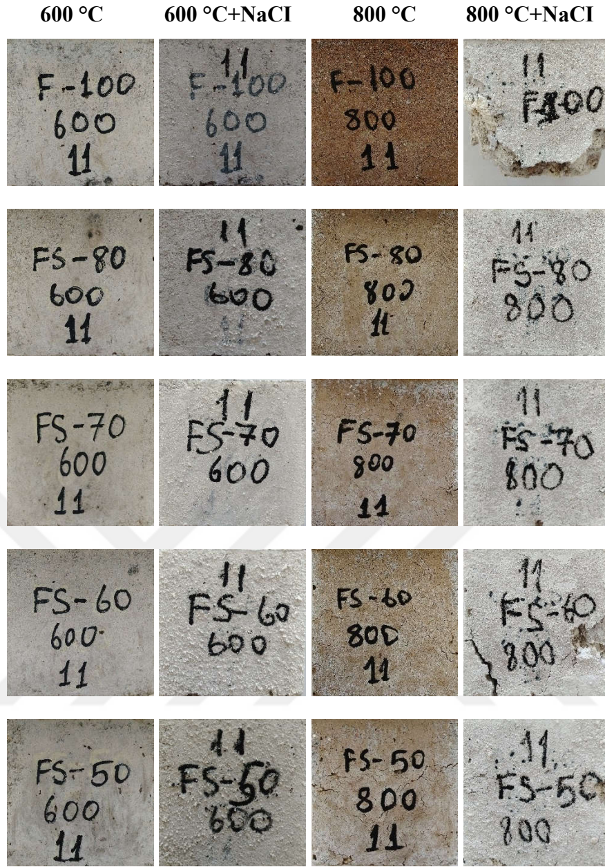
Şekil 61. 600°C+NaCl ve 800°C+NaCl sonrası numunelerin fiziksel görünümü
