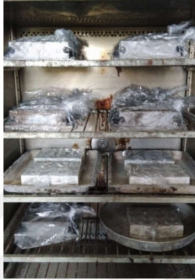
Şekil 35. Numunelerin poşetlenmesi ve ısı kürü
