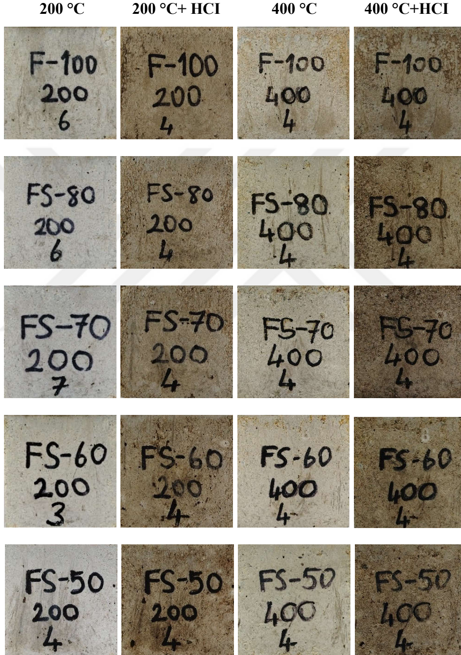
Şekil 50. 200°C+ HCl ve 400°C+ HCl sonrası numunelerin fiziksel görünümü
