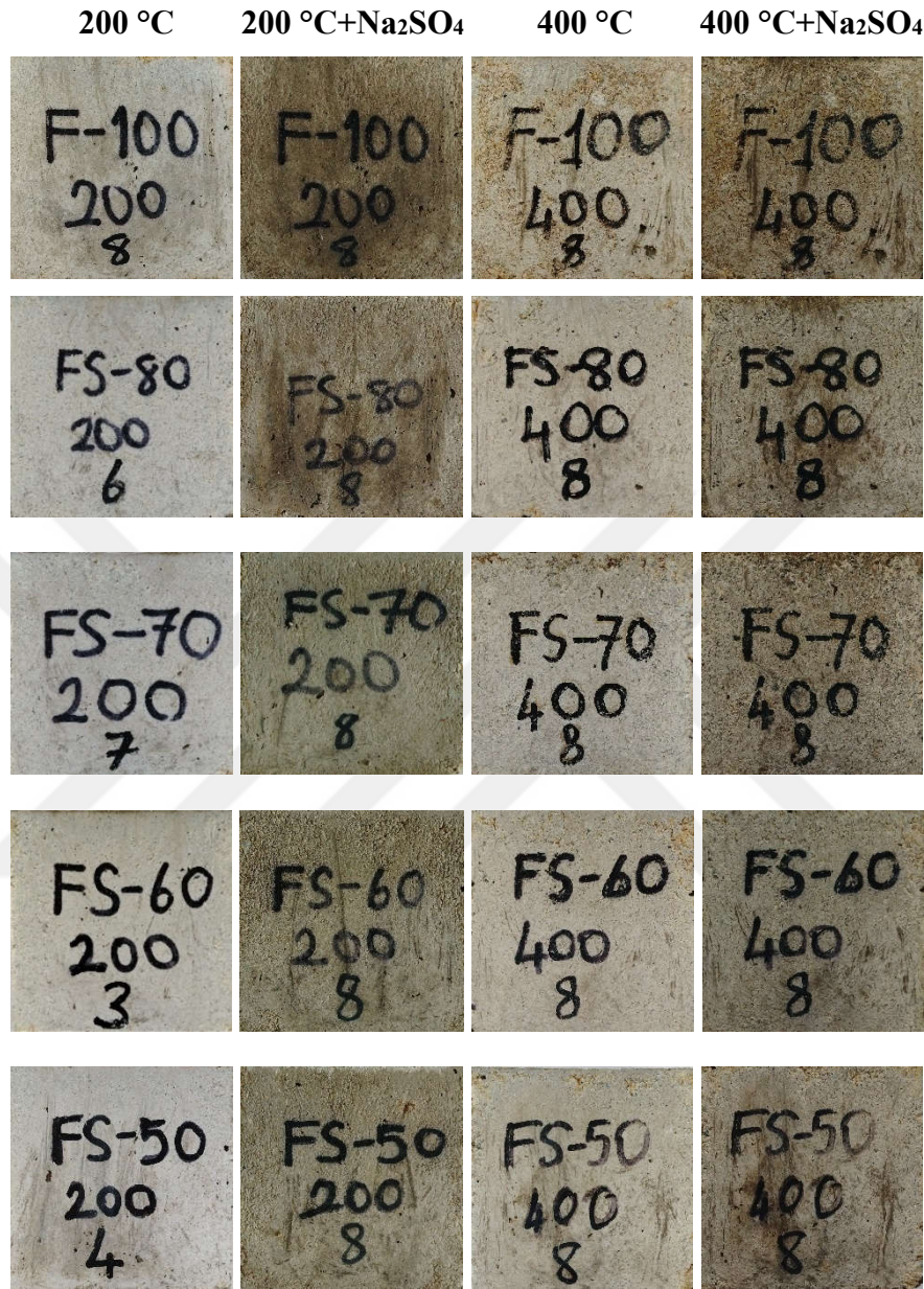
Şekil 55. 200°C+ \text{Na}_2\text{SO}_4 ve 400°C+ \text{Na}_2\text{SO}_4 sonrası numunelerin fiziksel görünümü
