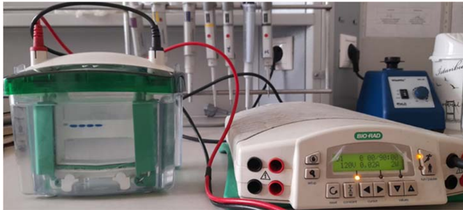
Şekil 13. 120 Volt elektriksel alanda protein örneklerinin yürütülmesi işlemi
