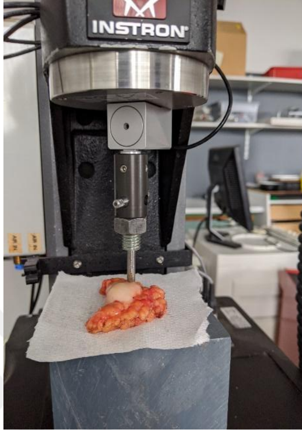
Şekil 3.2: Peritoneal metastazlı insan kolon adenokarsinomu örneği ile Instron giricilik test sistemi düzeneği
