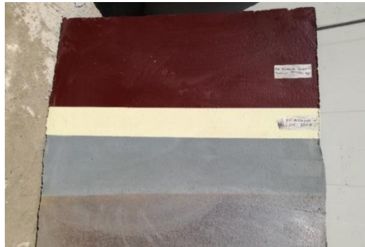
Şekil 4.24 : Ga Gazometresi soğuk galvaniz kaplama, astar ve boya katmanları numune uygulaması (Gürsoy Grup Restorasyon, 2015).
