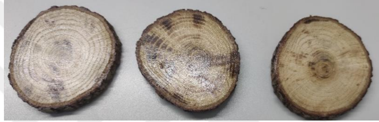
Şekil 4.20 Sırasıyla WPU, WPUNCC-3 ve WPUSNCC-3 vernikleri uygulanmış ahşap örnekler
