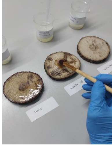
Şekil 3.10 Ahşaplara fırça ile poliüretan vernik uygulanması
